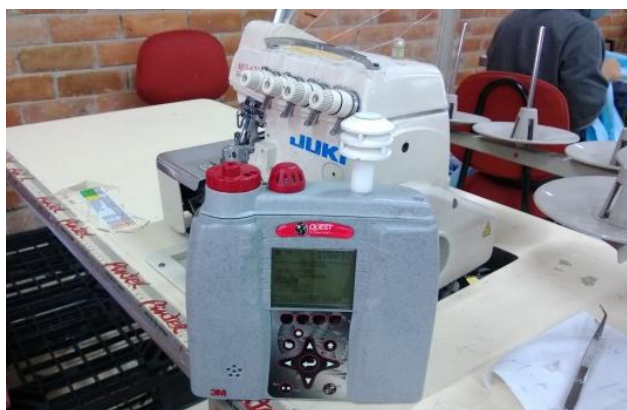
Figura 4.27 Toma de muestra en máquina overlock 2 grupo 3
