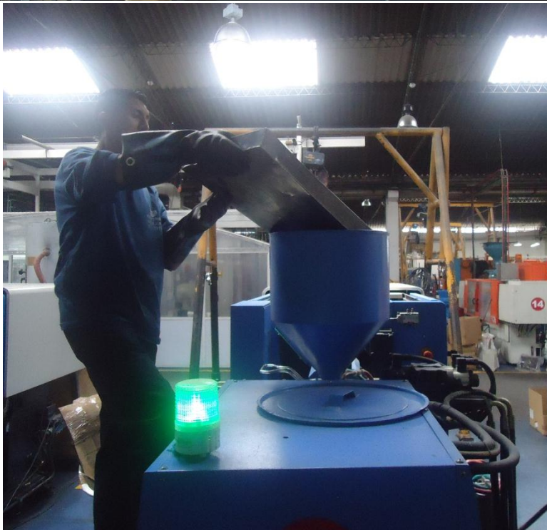
Fuente: Industrias Iepesa – Máquina Inyectora – Colocación Materia Prima
