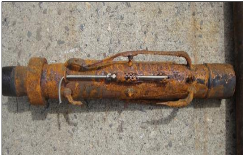
Figura 2. Corrosión uniforme en centralizador
