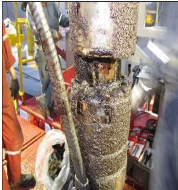
Figura 21. Incrustación en motor de fondo
