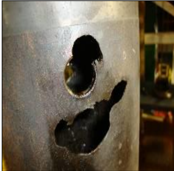
Figura 6. Corrosión por fisura en motor de fondo
