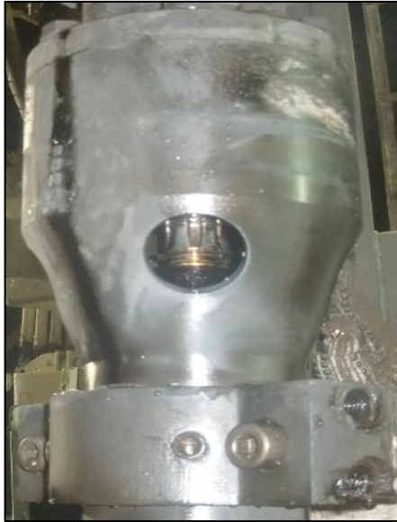
Figura 37. Ingreso a la bomba, INTAKE
