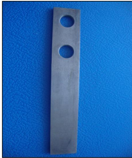
Figura 11. Cupón de corrosión 7.62 cm
