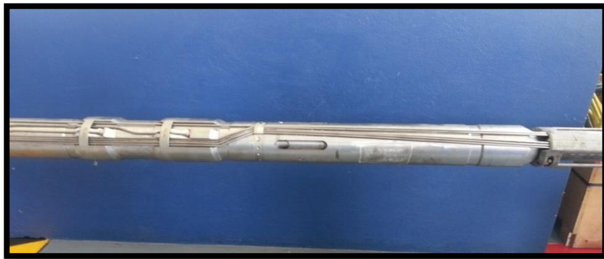
Figura 4. Válvula de Control de Flujo
