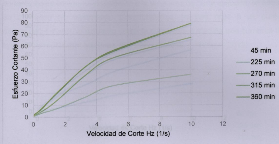
Figura 14. Esfuerzo cortante en relación a la velocidad de corte para leche fermentada con 2.5 % en la fermentación.
