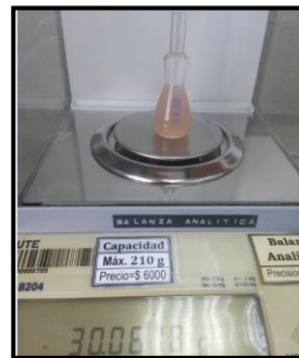
Pesado del picnómetro con la muestra de la bebida
