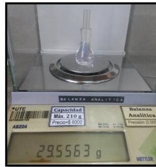
Pesado del picnómetro con agua destilada
