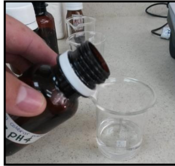
Calibración del pH-metro
