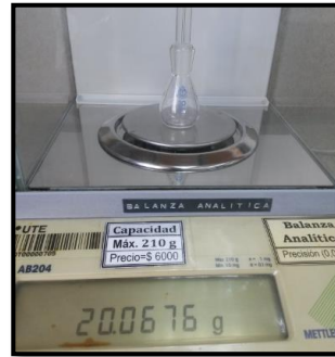
Pesado de picnómetro vacío
