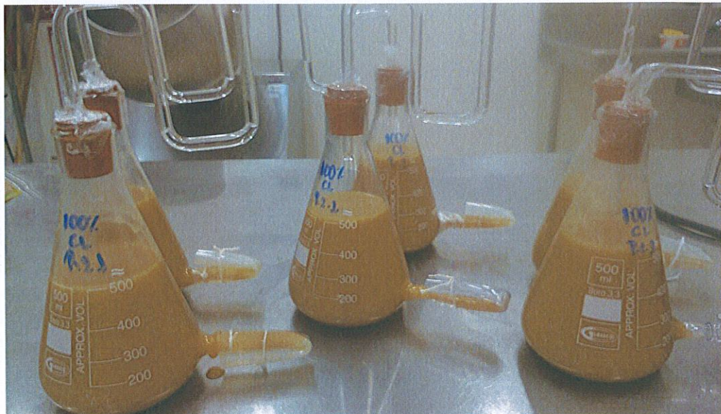
Figura 3. Fotografía de micro fermentadores del proceso de fermentación de la chicha de arroz.
