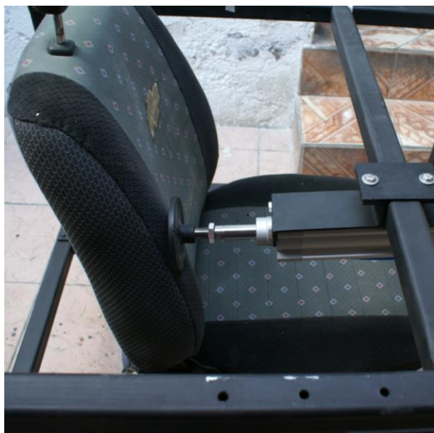
Figura 51. Cilindro en reposo prueba de la articulación del asiento.
