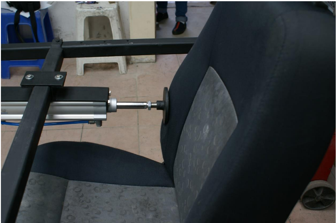
Figura 66. Prueba en articulación (Volkswagen Gol)
