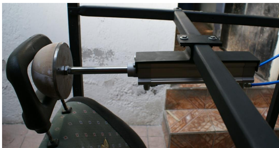
Figura 46. Aplicación de carga en el apoyacabezas
