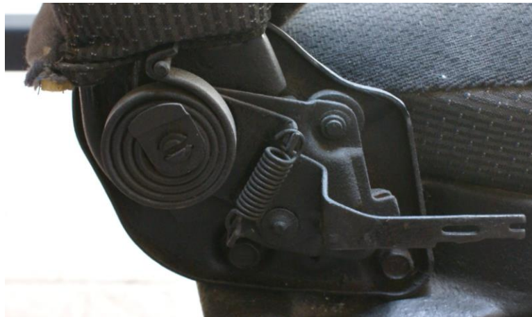
Figura 61. Articulación después de la prueba
