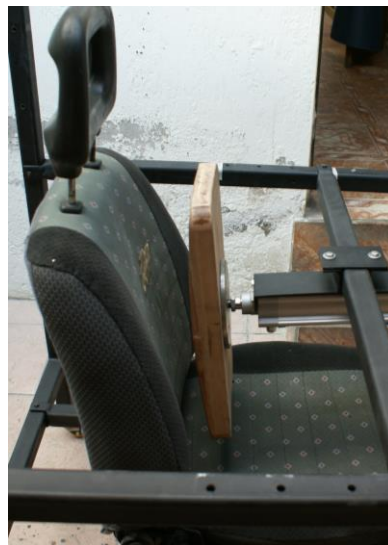
Figura 49. Cilindro en reposo ensayo del espaldar
