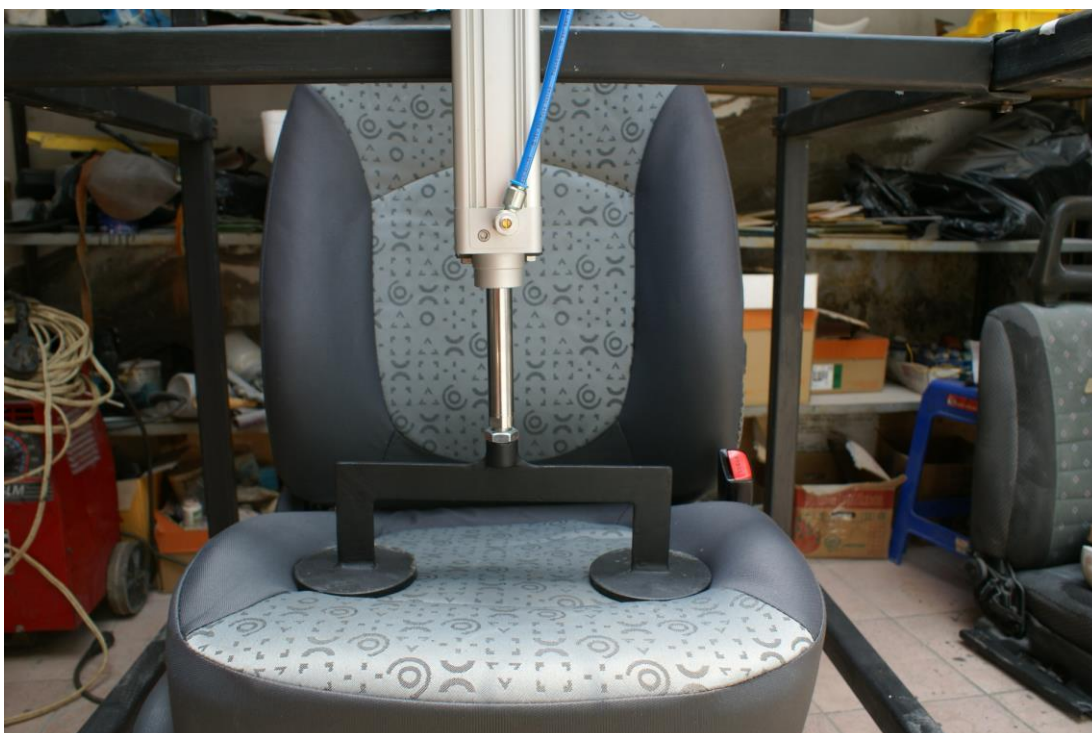
Figura 71. Prueba en respaldo (Chevrolet Spark)
