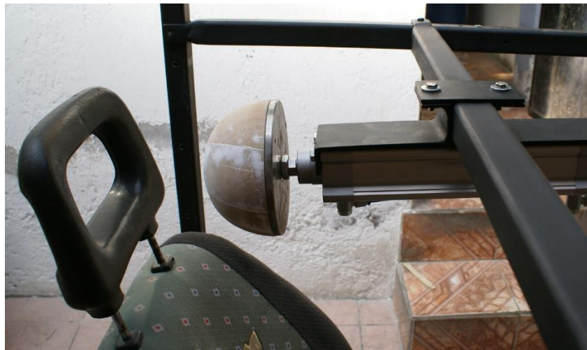
Figura 45. Retroceso del cilindro en prueba del apoyacabezas
