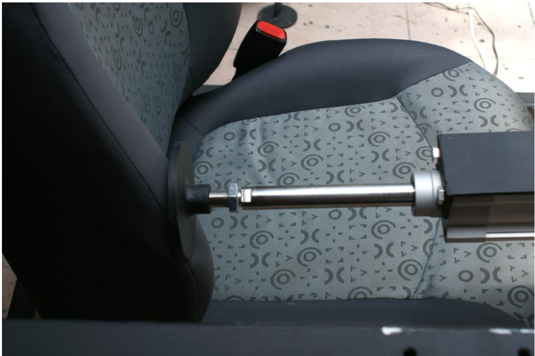
Figura 74. Prueba en articulación (Chevrolet Spark)
