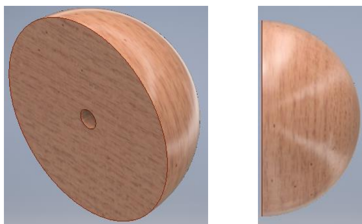
Figura 25. Indentador para ensayos de apoyacabezas, diferentes vistas.
