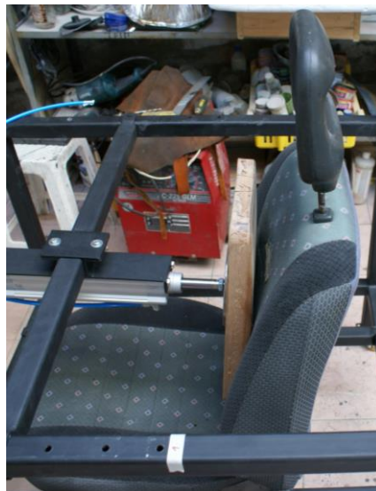
Figura 50. Aplicación de fuerza prueba en el espaldar
