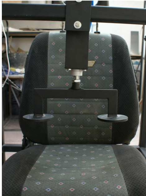
Figura 47. Cilindro en reposo en prueba de asiento
