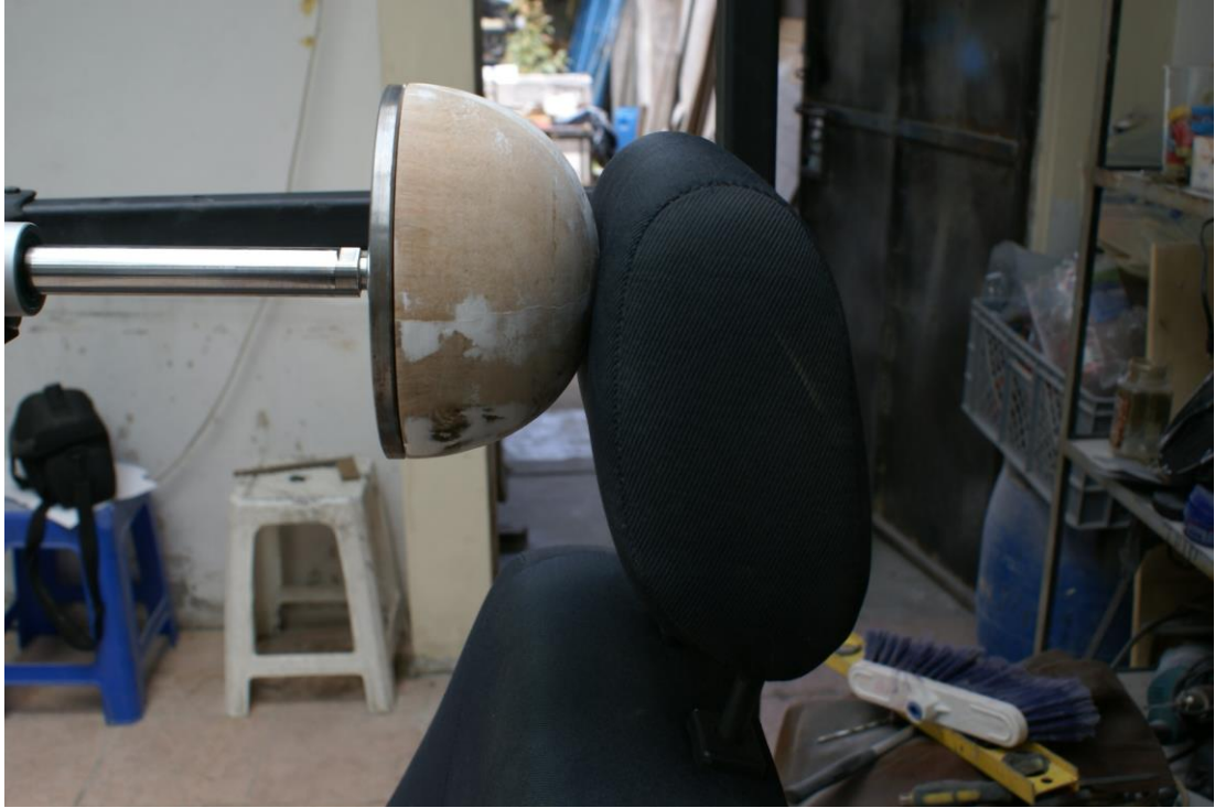
Figura 65. Prueba en apoyacabezas (Volkswagen Gol)
