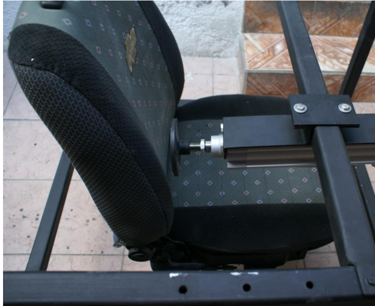
Figura 51. Cilindro en reposo prueba de la articulación del asiento.
