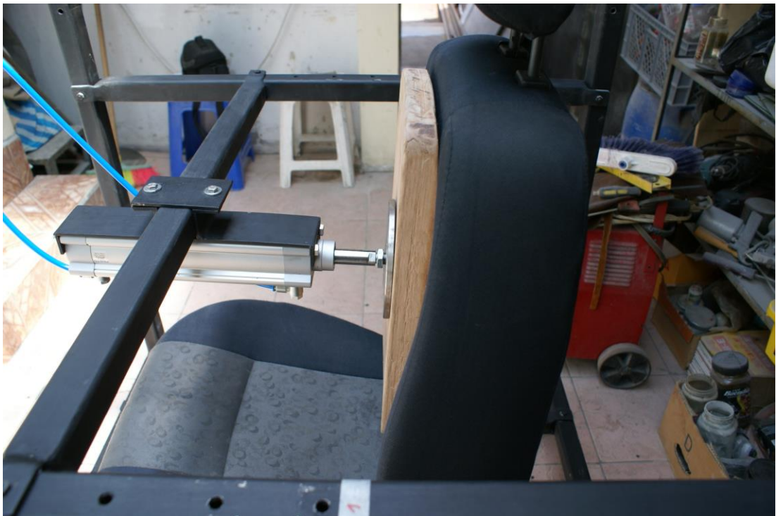
Figura 64. Prueba en espaldar (Volkswagen Gol)
