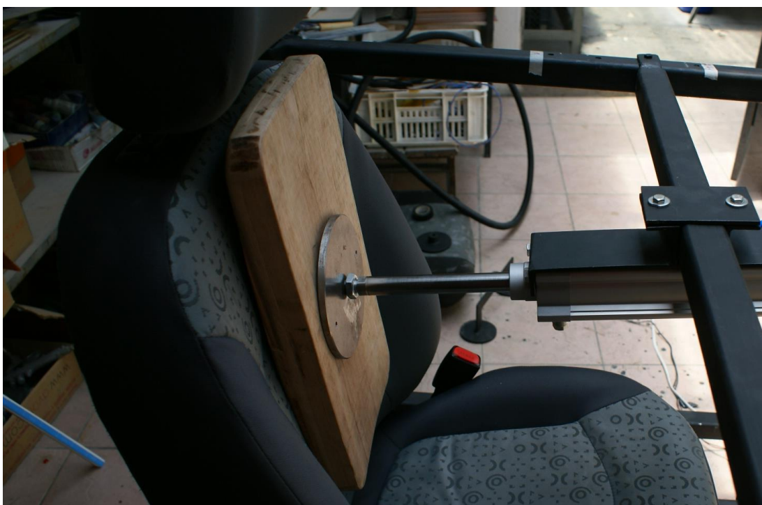
Figura 72. Prueba en respaldo (Chevrolet Spark)
