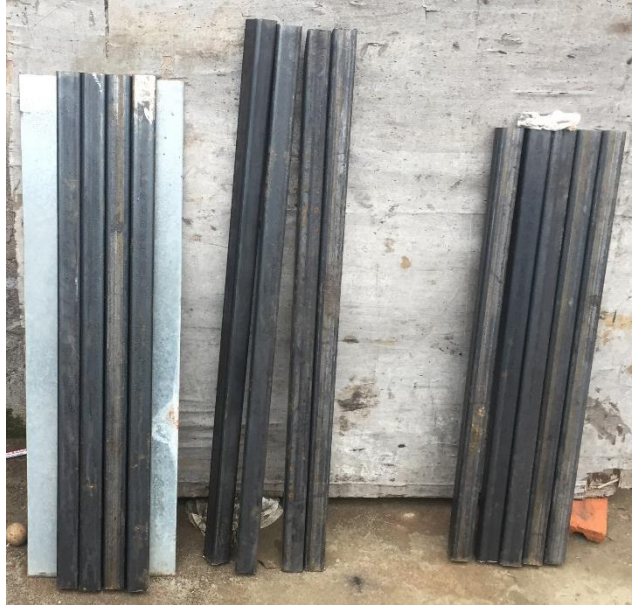
Figura 35. Corte del tubo cuadrado
