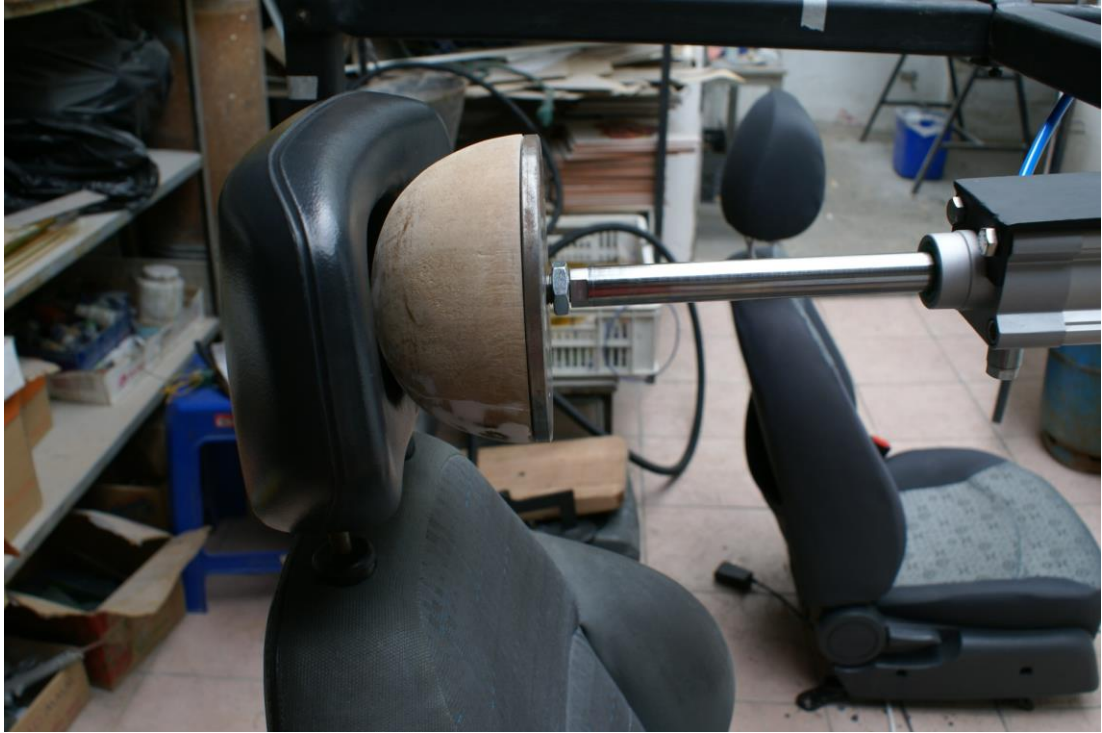
Figura 69. Prueba en apoyacabezas (Chevrolet Vitara)
