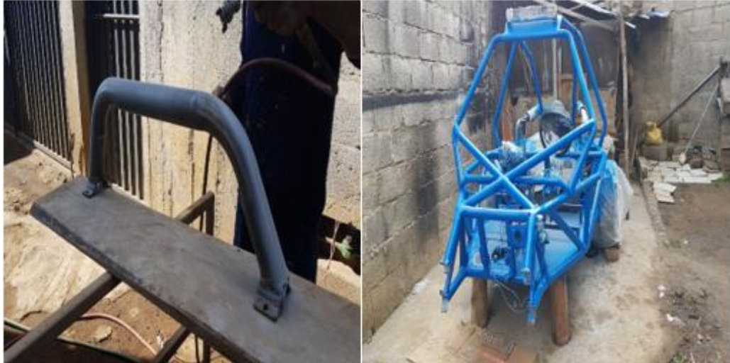
Figura 35. Proceso de pintura
