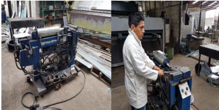
Figura 33. Doblado de los tubos
