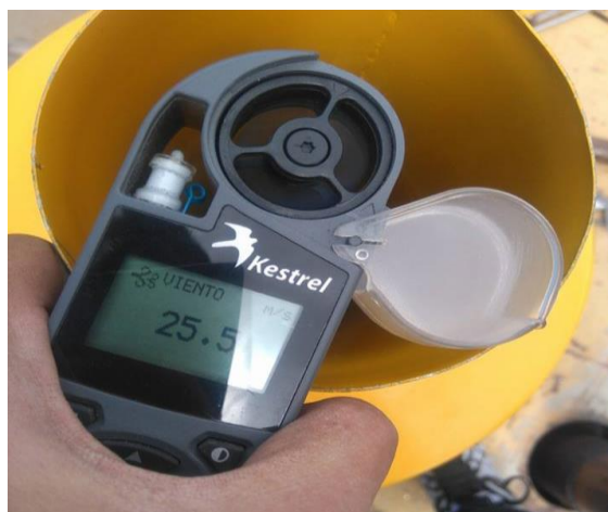
Figura 17. Medición de la velocidad de admisión del aire con sistema de doble filtración
