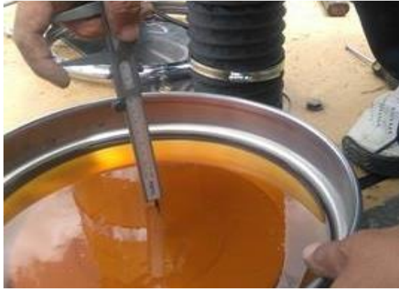
Figura 16. Nivel de aceite de la tasa del filtro de aire bañado en aceite
