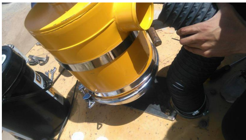
Figura 15. Colocación del tubo acordeón
