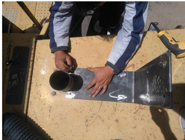
Figura 13. Trazo de puntos de la tapa del motor para fijación de la base del filtro.
