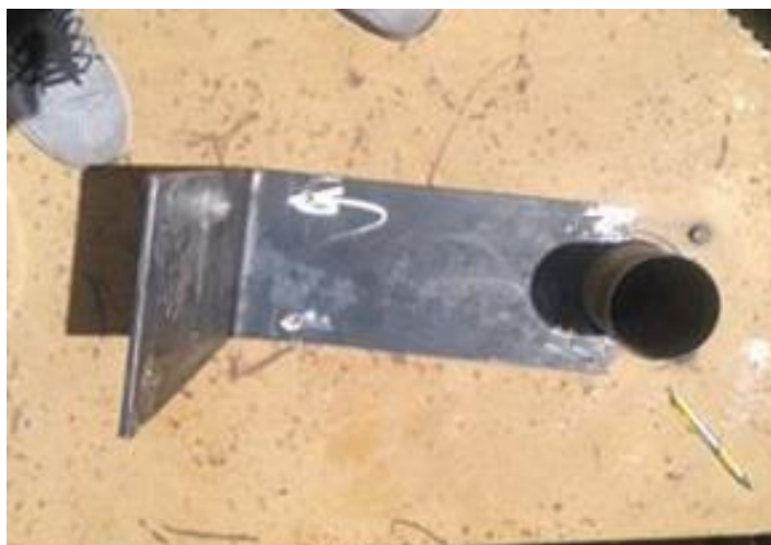
Figura 12. Perforación para paso del tubo de admisión de aire.
