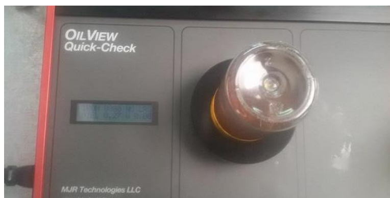
Figura 26. Medidas obtenidas con analizador OilView a aceite del filtro de aire bañado en aceite
