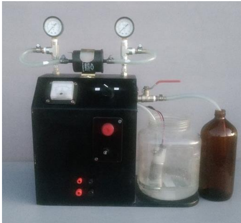
Figura 10. Banco para pruebas de funcionamiento de filtros
