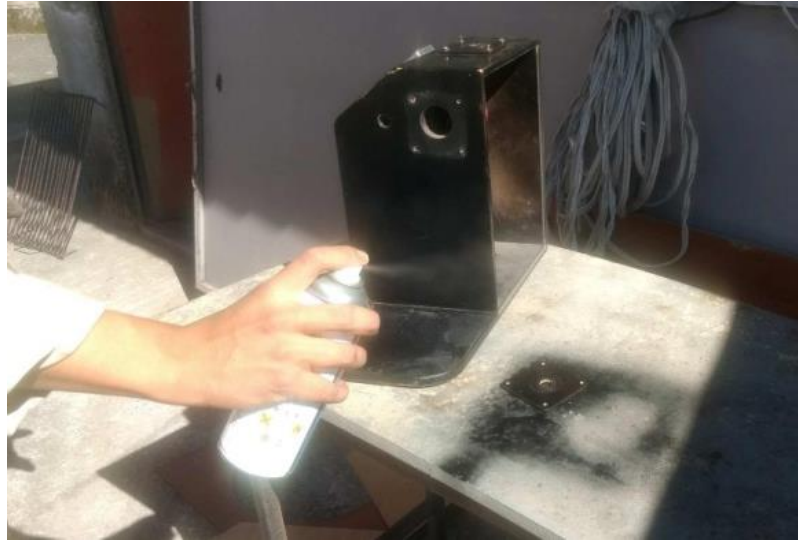
Figura 8. Pintado de la estructura armada
