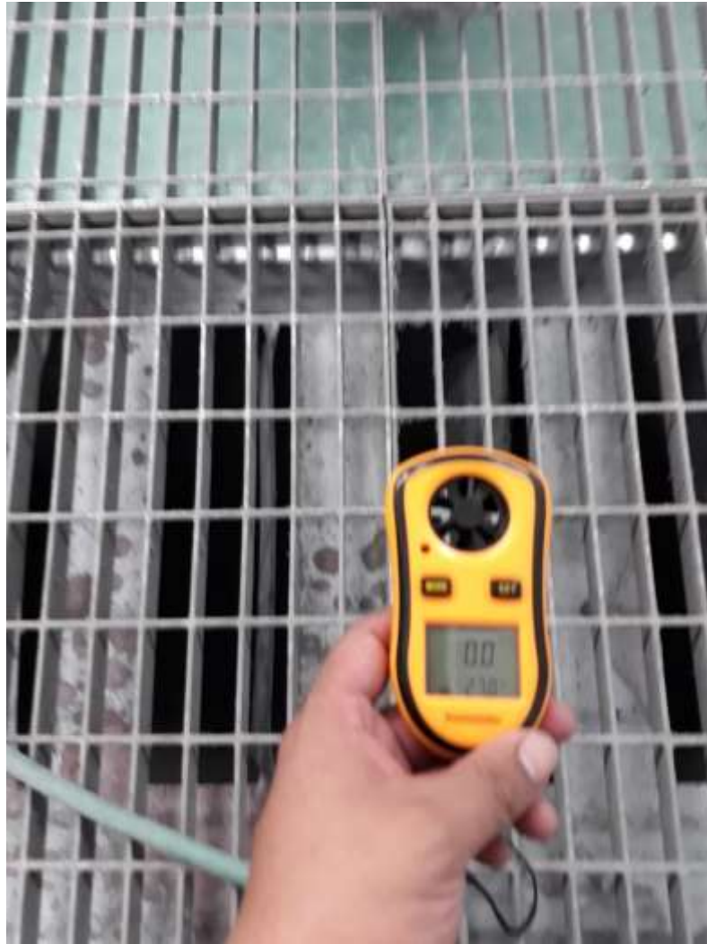
Figura 7. Toma de flujo de aire cabinas de pintura
