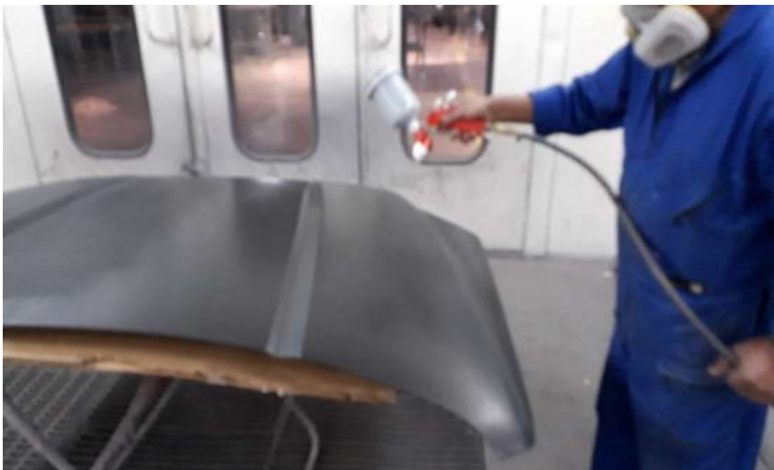
Figura 5. Aplicación de pintura.
