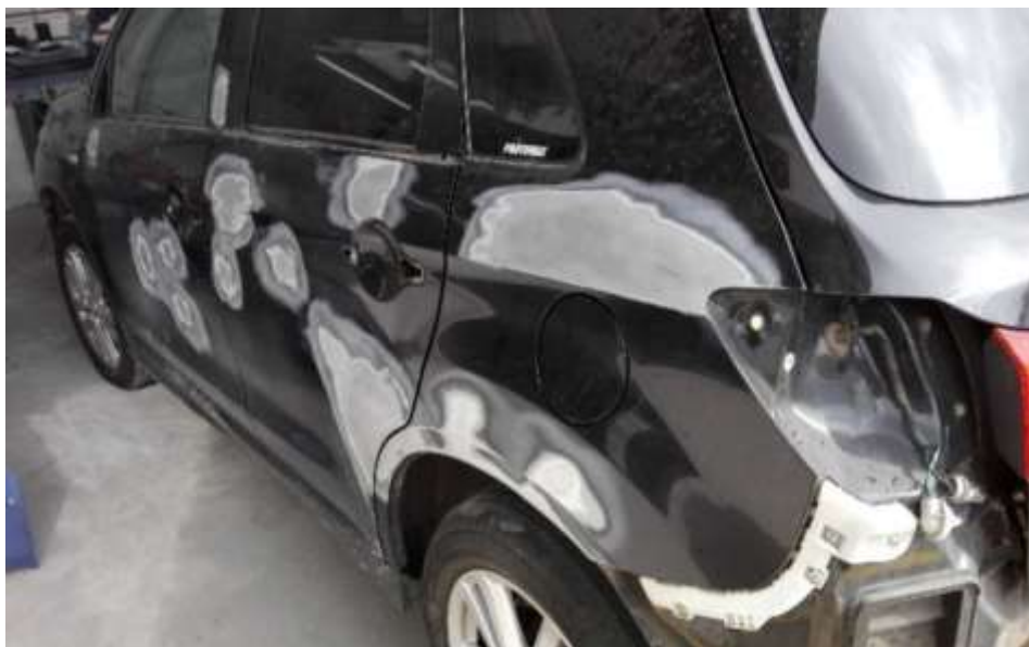
Figura 3. Proceso de biselado de reparación
