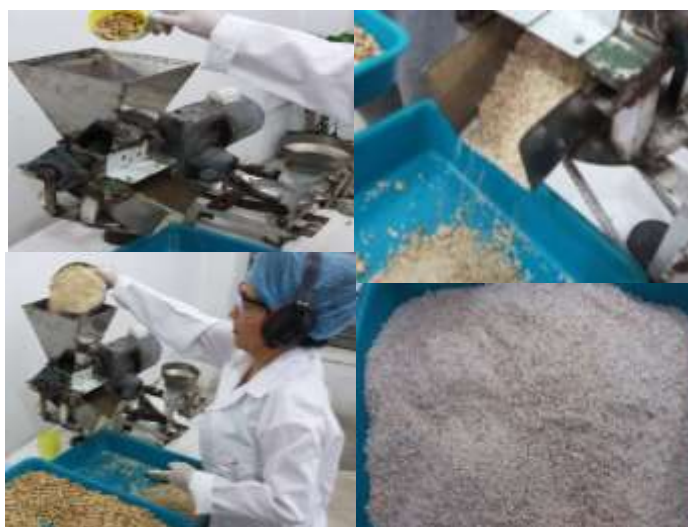
Figura 11. Colocación de la almendra en sus 2 etapas de triturado.
