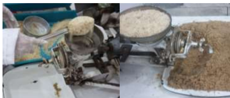
Figura 12: Colocación de la almendra triturada en el molino. EMEXPRORAMEC
