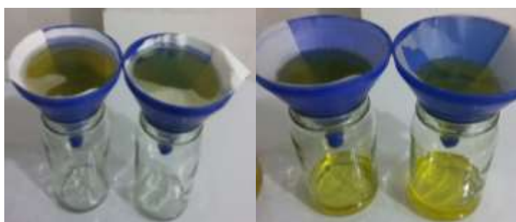
Figura 15. Filtrado del aceite mediante papel filtro.
