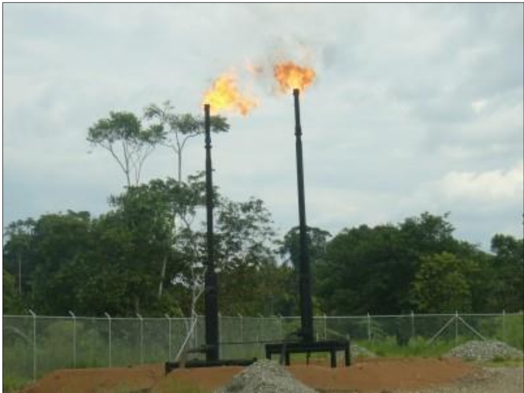
Figura 4. Mecheros para quema de gas natural asociado
