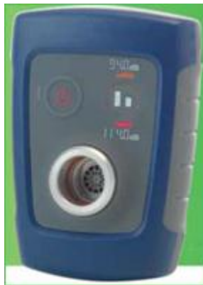
Figura 13. Calibrador CASELLA de la serie CEL- 120 Elaborado por: El autor
