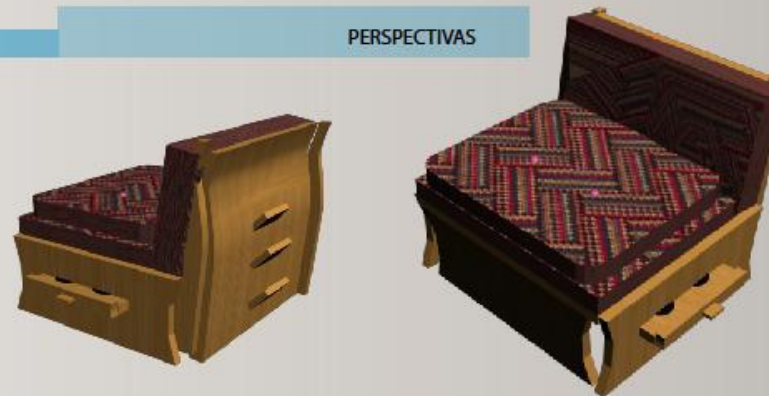
TELA (TEJIDO) ROSA ESPESOR: 2 mm LUGAR: ESPALDAR/ASIENTO COCIDA A ESPONJA CADA 1cm
