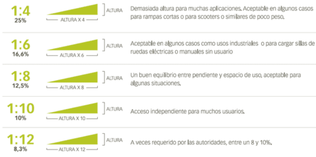
FIGURA 105 Especificaciones básicas para definir el largo de una rampa de discapacitados. FUENTE: www.mundorampas.com
