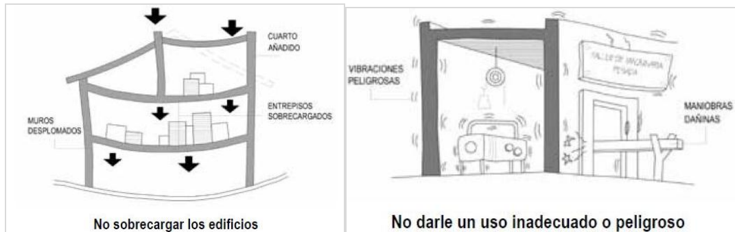
Gráfico 25. Muros desplomados, vibraciones peligrosas
