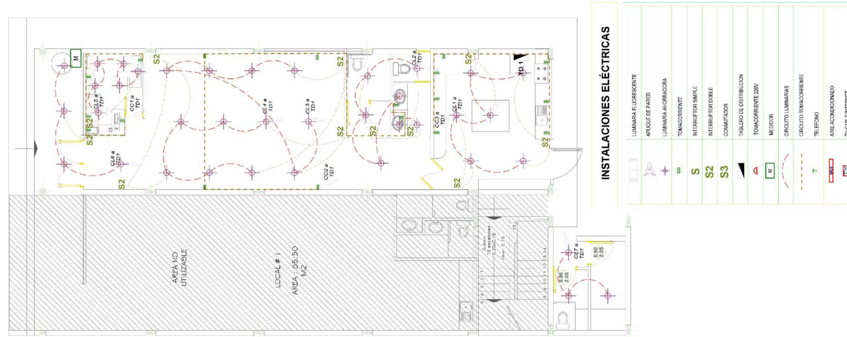
INSTALACIONES ELÉCTRICAS Planta Baja Escala 1:100
