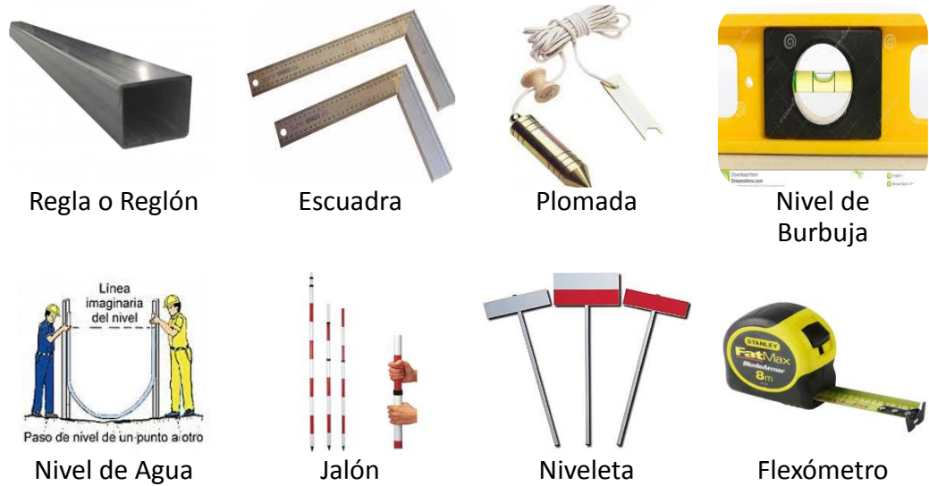
Figura 21 – Equipos y Materiales de Replanteo
