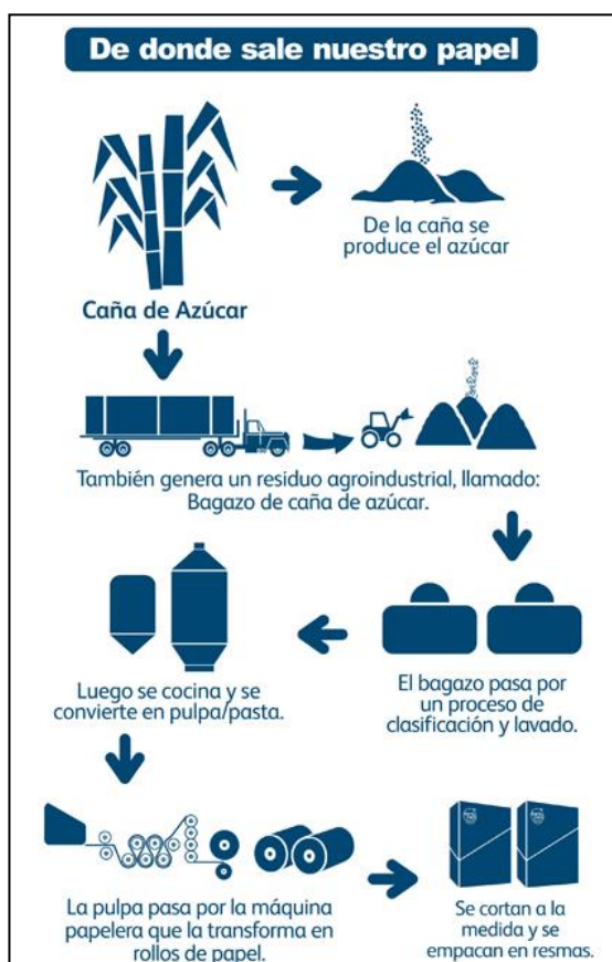
Imagen 31: Proceso de fabricación papel ecológico 100% caña de azúcar
