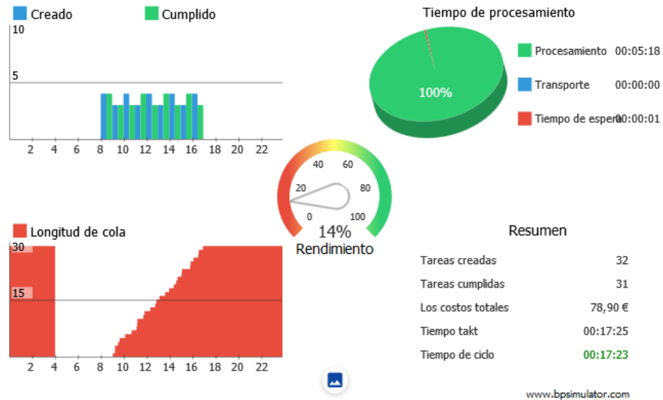
Figura 20 Tercer cuadro de Resultados de Simulación en el programa BP Simulator con la unificación de tareas.
