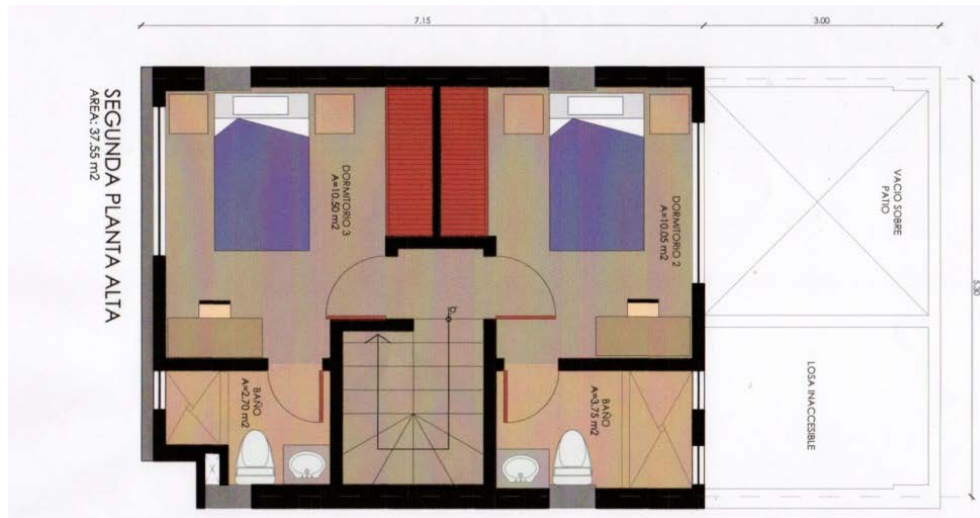
FIGURA 3.7 DISTRIBUCIÓN VIVIENDAS PLANTA ALTA
