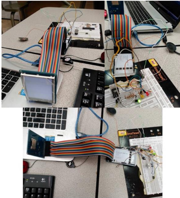
Figura 36. Sistema de validación del monitoreo de temperatura y humedad.
