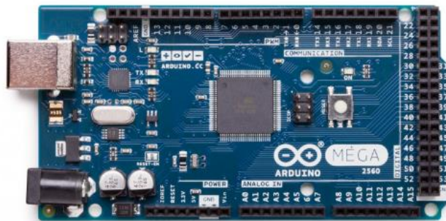
Figura 11. Placa Arduino Mega (Store, 2017)
