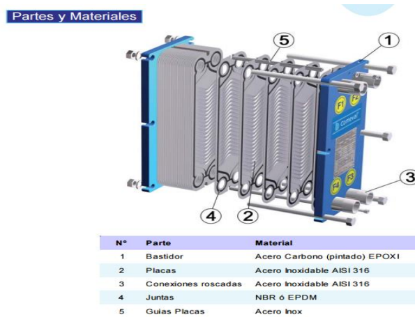
Figura 30. Intercambiador de tipo placas.
