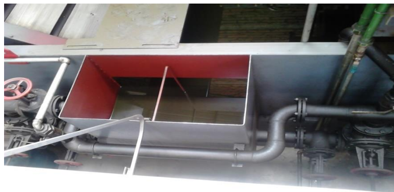
Figura 28. Tina de aceite a 180 °C para el proceso de Pavonado.
