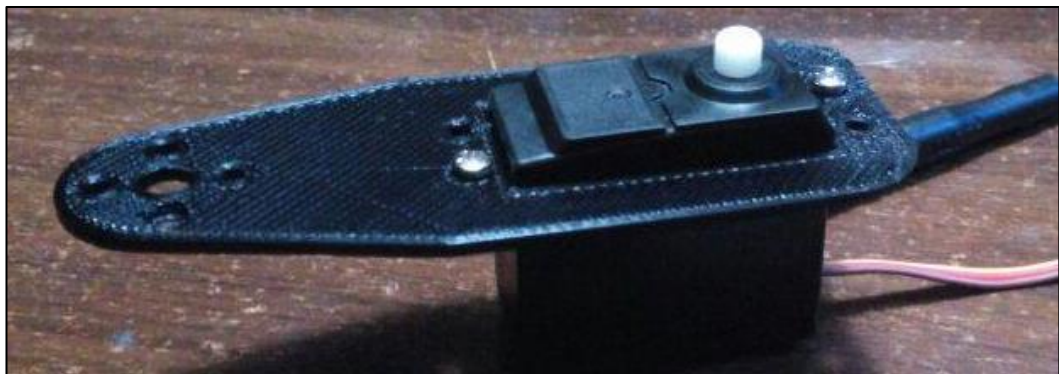
Figura 47. Acoplamiento de actuadores dentro de las piezas impresas
