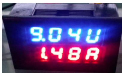
Figura 39. Medición de corriente y Voltaje en lector digital para carga resistiva de 10 \Omega /5Watts
