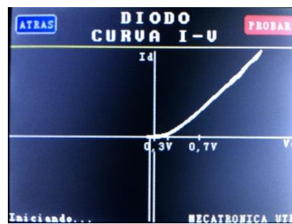
Figura 31. Curva característica de un diodo de germanio
