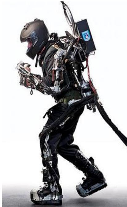
**Figura 2.** Prototipo moderno de exoesqueleto XOS
