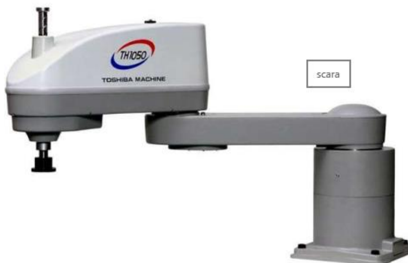
Figura 7. Manipulador de tipo mixto. (Tegruposete7, 2016)
