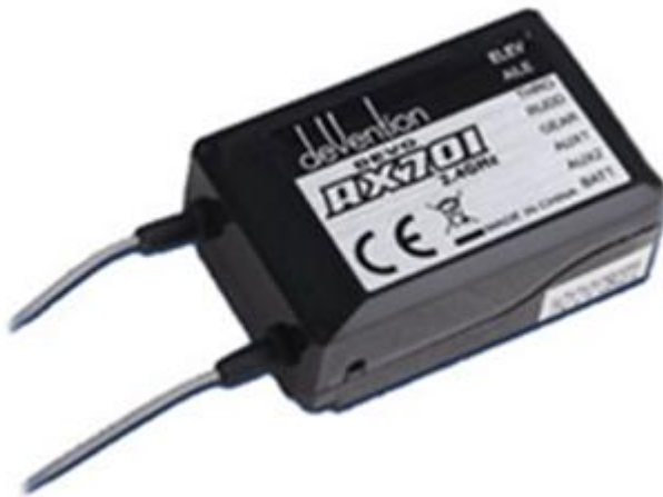
Figura 29. Receptor utilizado para el accionamiento de los motores y proporcionar movimiento a la plataforma móvil.
