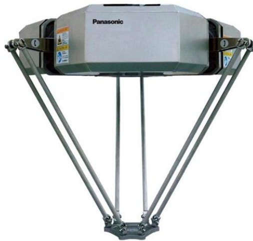
Figura 8. Manipulador de tipo paralelo. (Directindustry.es, 2016)
