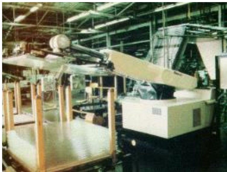
Figura 5. Manipulador de tipo polar. (González, 2002)
