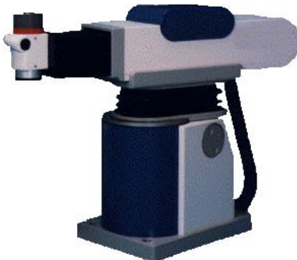
Figura 6. Manipulador de tipo esférico. (González, 2002)
