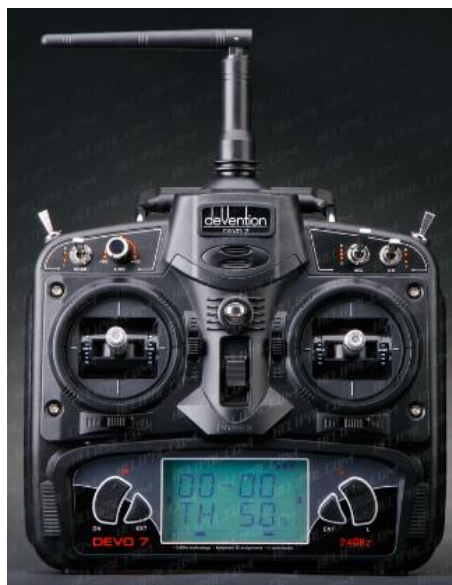
Figura 28. Emisor – Control a radio frecuencia utilizado para el accionamiento de los motores y proporcionar movimiento a la plataforma móvil.
