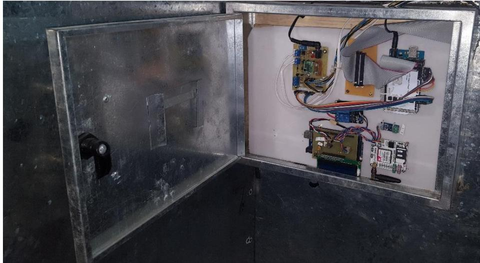
**Figura 36.** Sistema de control de la máquina completa ubicado en el panel de control
