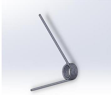
**Figura 12.** Resorte de torsión modelado en CAD
