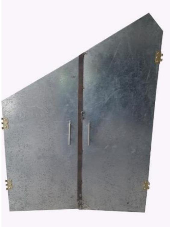
**Figura 34.** Puertas de la carcasa de la máquina recicladora
