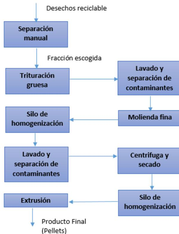
**Figura 1.** Proceso de reciclado mecánico avanzado
