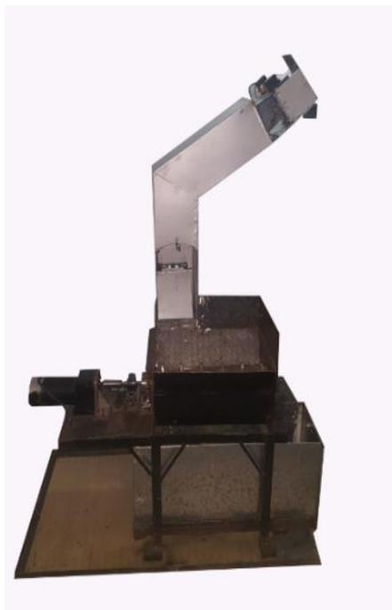
**Figura 29.** Vista lateral del ensamblaje mecánico completo del ducto y laminadora
