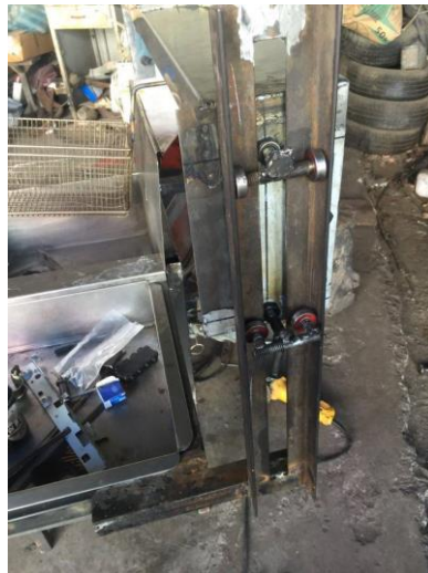
Figura 25. Riel guía para movimiento del mecanismo móvil.
