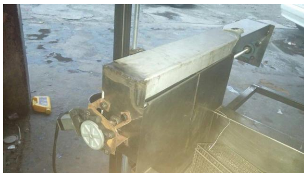
Figura 26. Instalación de actuadores en la freidora.
