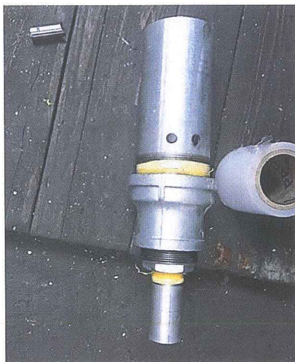
Figura 24. Cámara de calefacción
