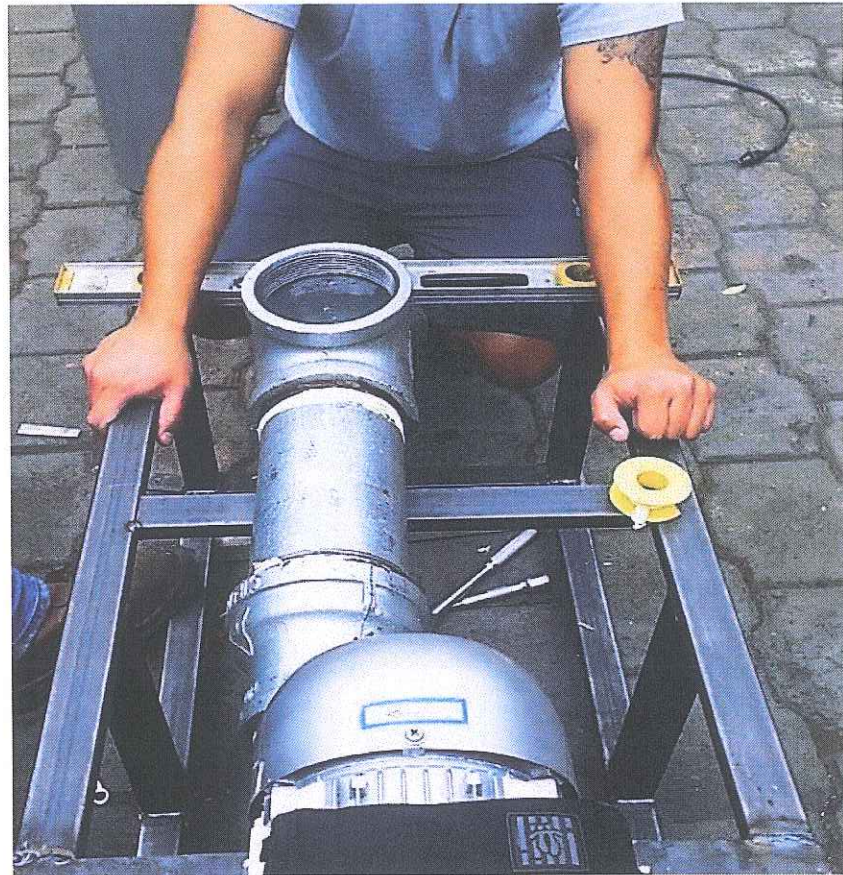
Figura 30. Armado de la estructura base 2
