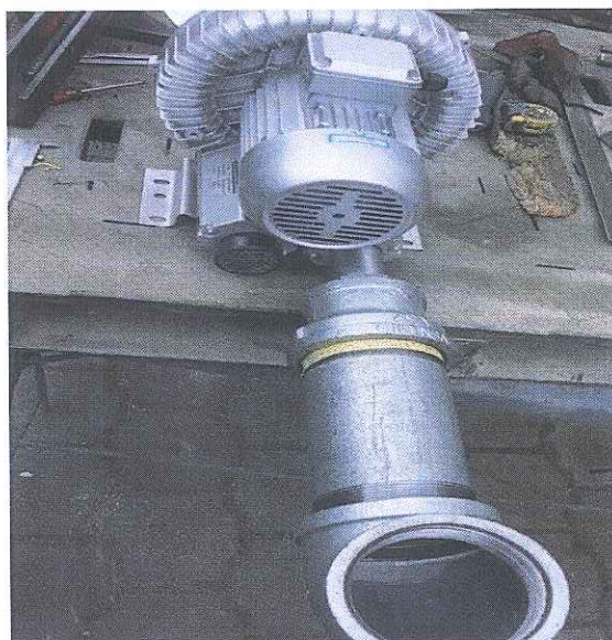
Figura 27. Ensamblaje blower y cámara de calefacción
