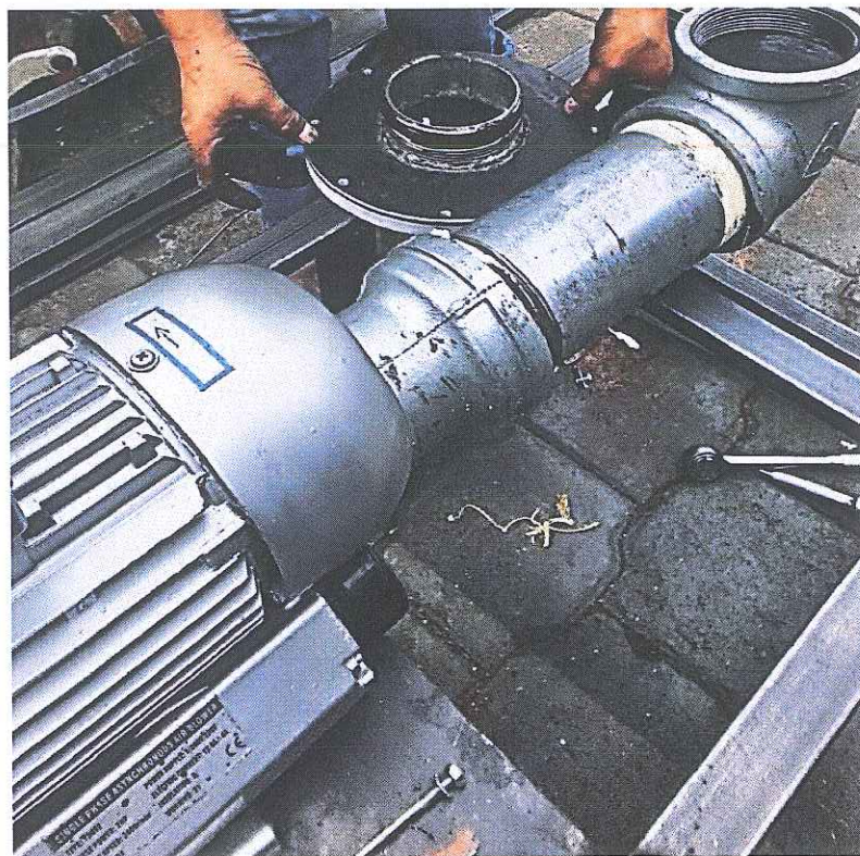
Figura 31. Ensamble base, blower y cámara de calefacción
