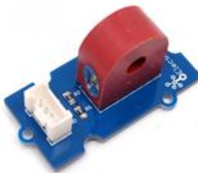
Figura 21. Transformador de corriente TA12-200
