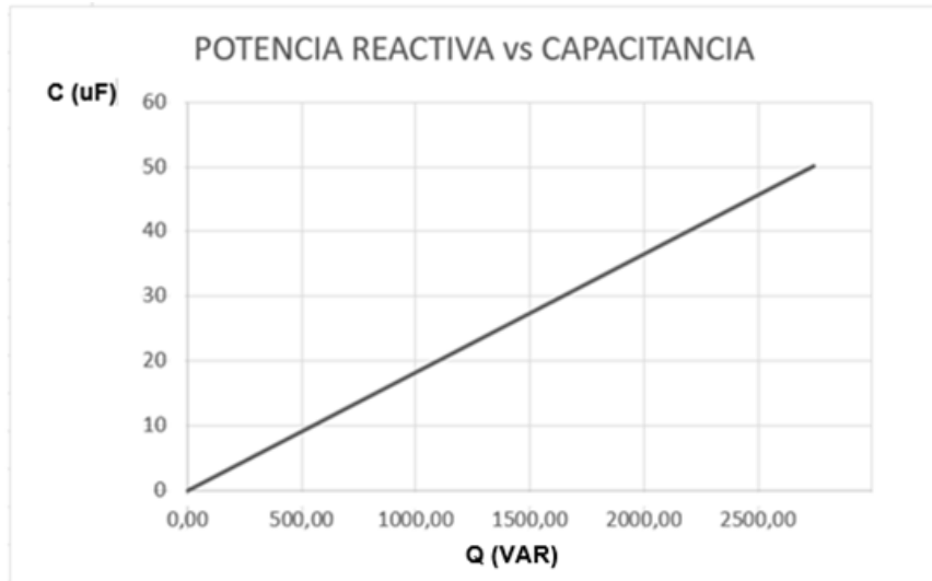
Figura 52. Potencia Reactiva vs. Capacitancia.
