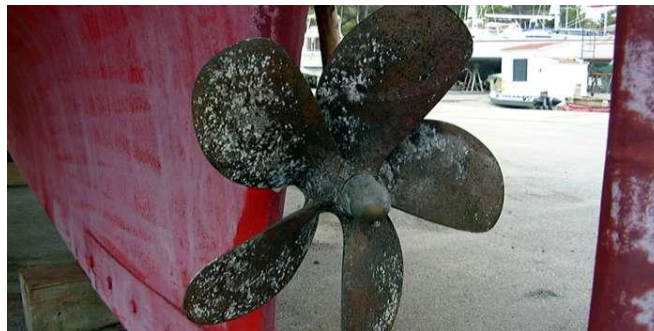
Figura 27 Hélice marina con daño de Cavitación
