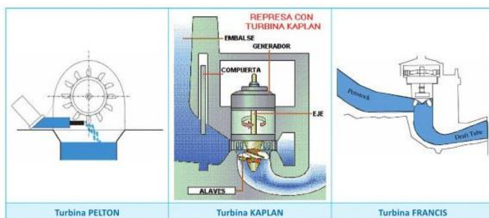
Figura 11 Tipos de Turbomáquinas por dirección de flujo
