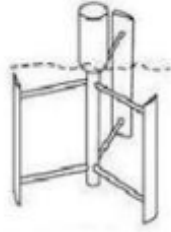
Figura 26 Turbina Darrieus-H Eje Vertical y Paletas Rectas
