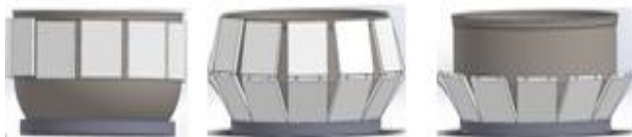
Figura 6: Disposiciones de los módulos termoeléctricos propuestos en una olla redonda
