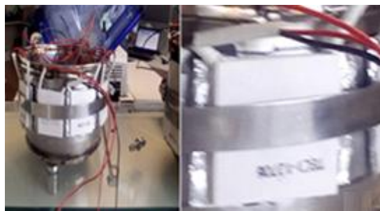
Figura 9: Módulos termoeléctricos instalados en la olla redonda
