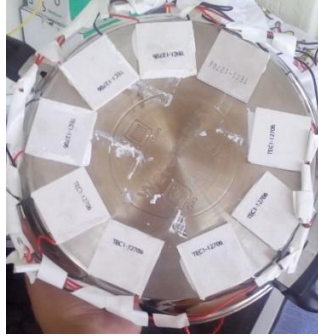
Figura 10: Módulos Instalados en la base del sartén
