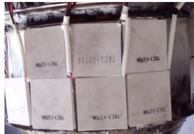
Figura 11: Módulos termoelectricos instalados en la olla pentadecágona
