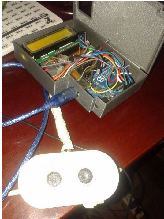
Figura 36. Dispositivo en funcionamiento con módulo bluetooth
