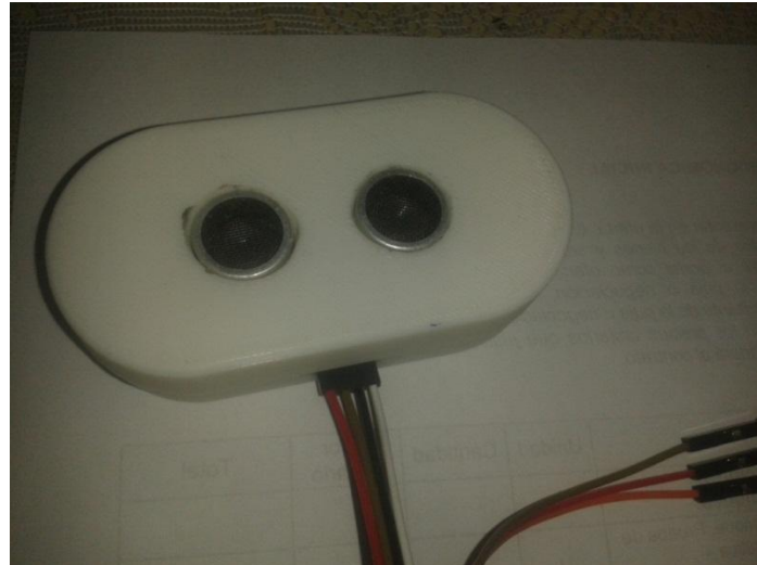
Figura 28. Armazón para el sensor de ultrasonido (Fuente: Autor)
