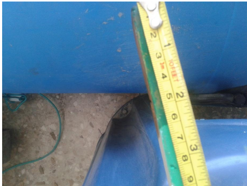
Figura 38. Medición con vara de madera simulando varilla de aforo para medir combustible (Fuente: Autor)
