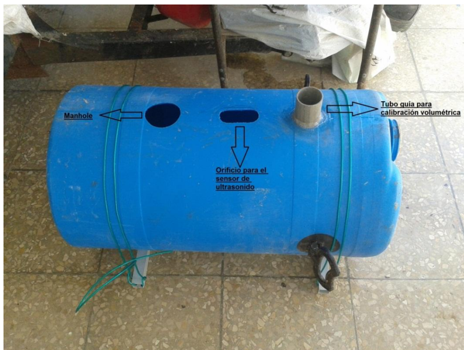
Figura 31. Tanque semejante a uno real con adecuaciones para el elemento electrónico
