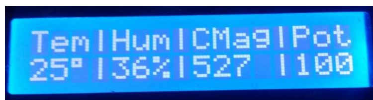
Figura 32. Señales obtenidas de los sensores y mostradas en LCD
