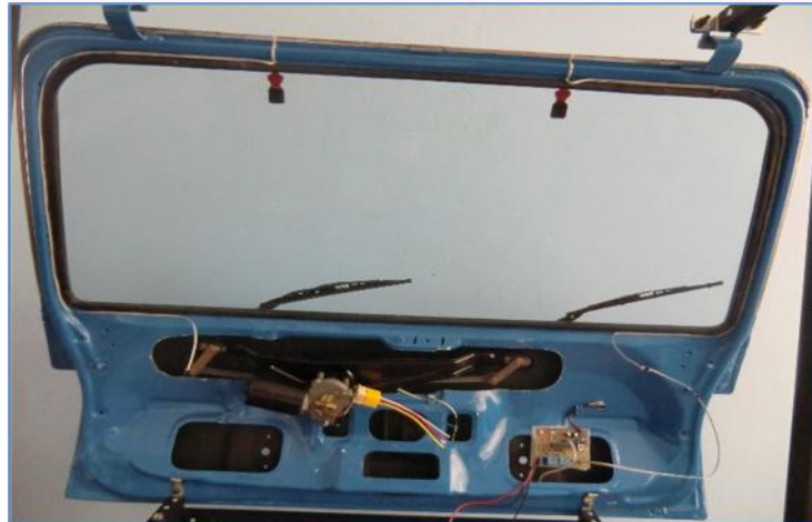
Figura 37. Cableado y puesta de placa de control
