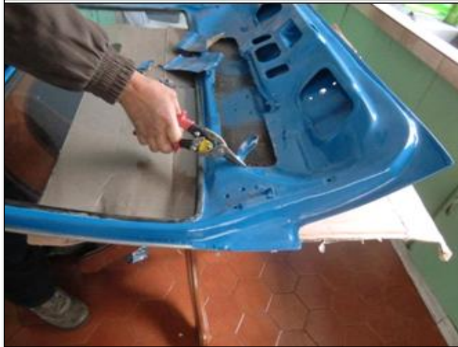
Figura 29. Cortes en la parte interior de la compuerta
