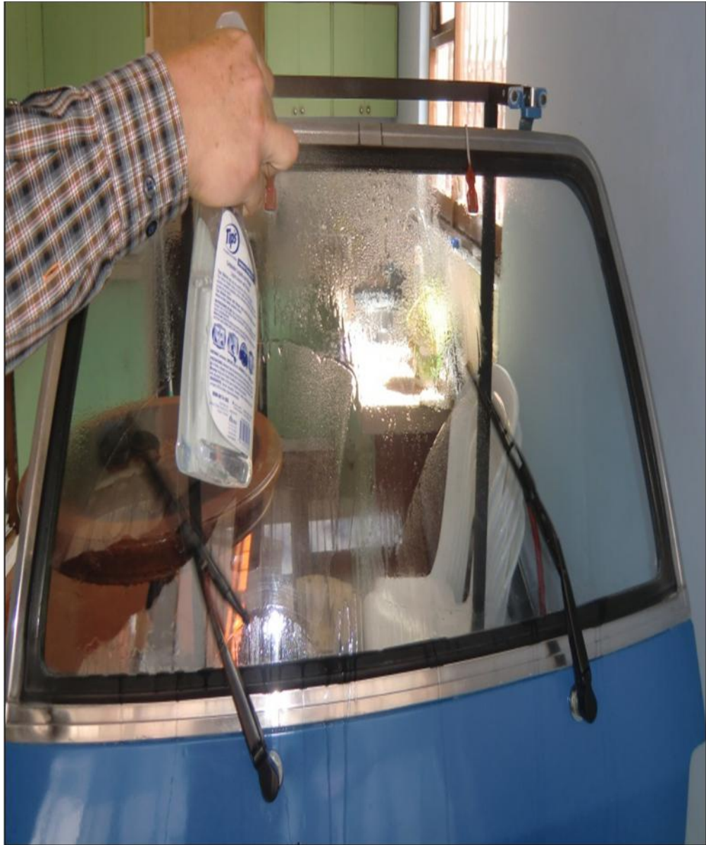
Figura 49 Aspersion en el sensor
