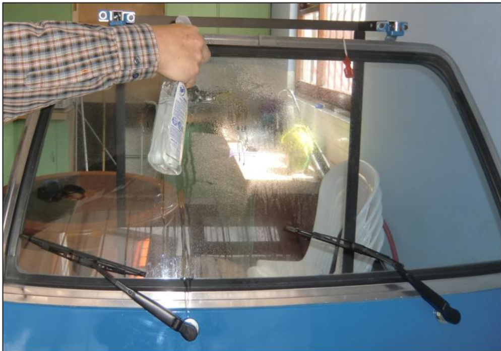
Figura 48 Aspersion de agua solo al vidrio
