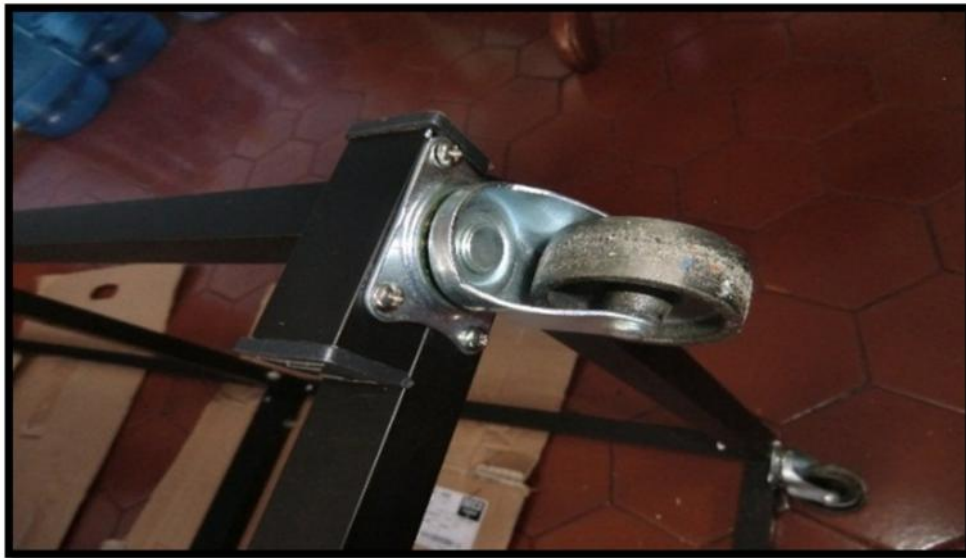
Figura 34. Colocación de las llantas en el bastidor
