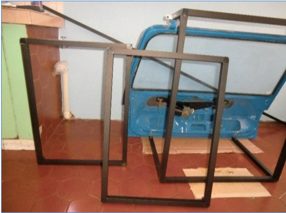
Figura 33. Construcción de la parte inferior del Bastidor
