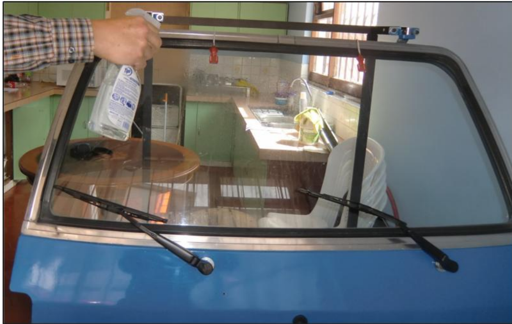
Figura 47 Inicio de la aspersion de agua
