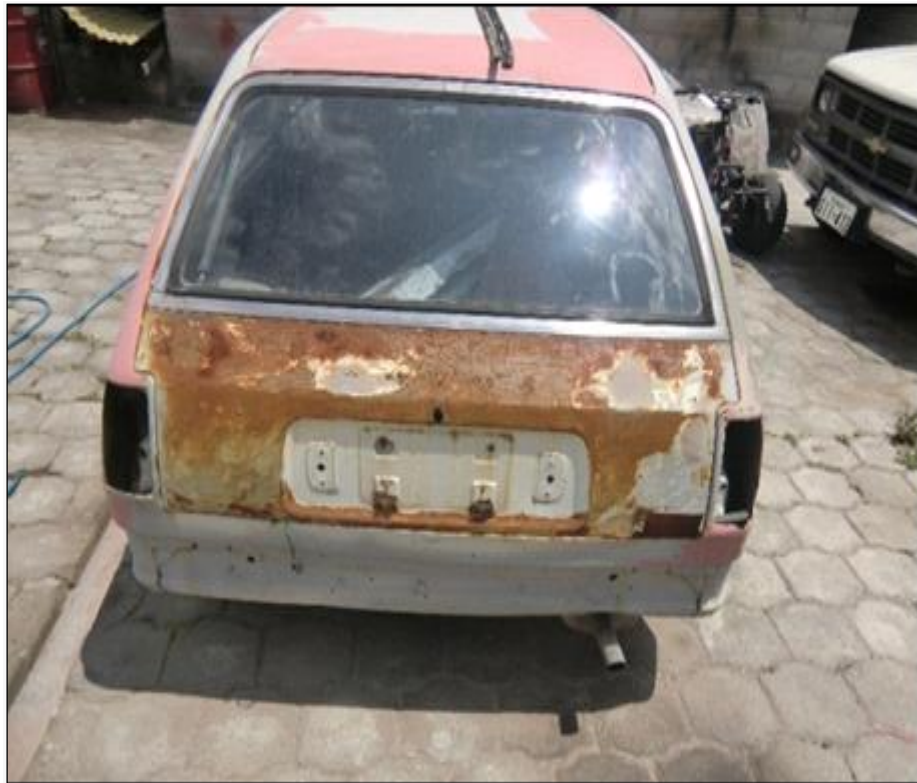
Figura 28. Desmontada de Compuerta
