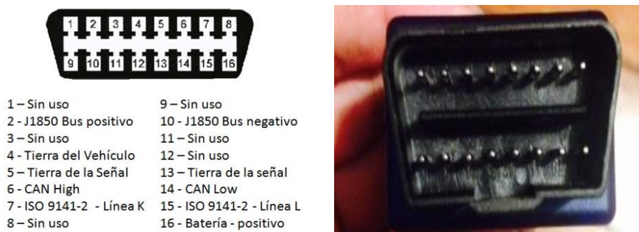
Figura 30 Pines del terminal de conexión del OBD II
