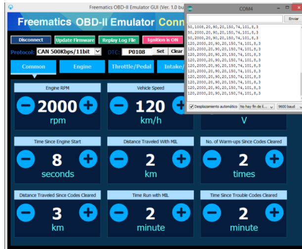
Figura 68 Pruebas de adquisición de datos desde el monitor serial de la placa de desarrollo
