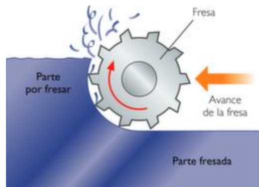
Figura 8. Operación corte en fresadora (Wordpress, 2011)
