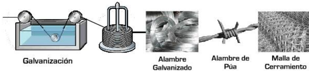
Figura 37. Proceso de Trefilación- Paso 3 (Adelca, 2015)
