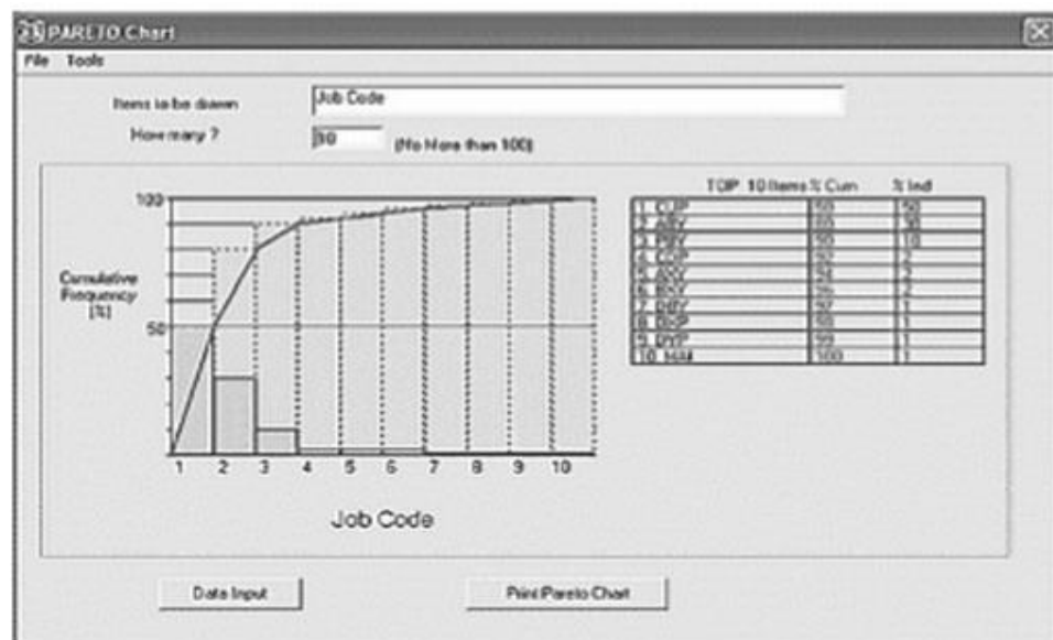
Figura 1.- Distribución de Pareto de accidentes industriales. 20% de los códigos de trabajo (CUP y ABY) provocan alrededor de 80% de los accidentes (Niebel & Freivalds, 2014). Ingeniería Industrial: Métodos Estándares y Diseños del Trabajo.
