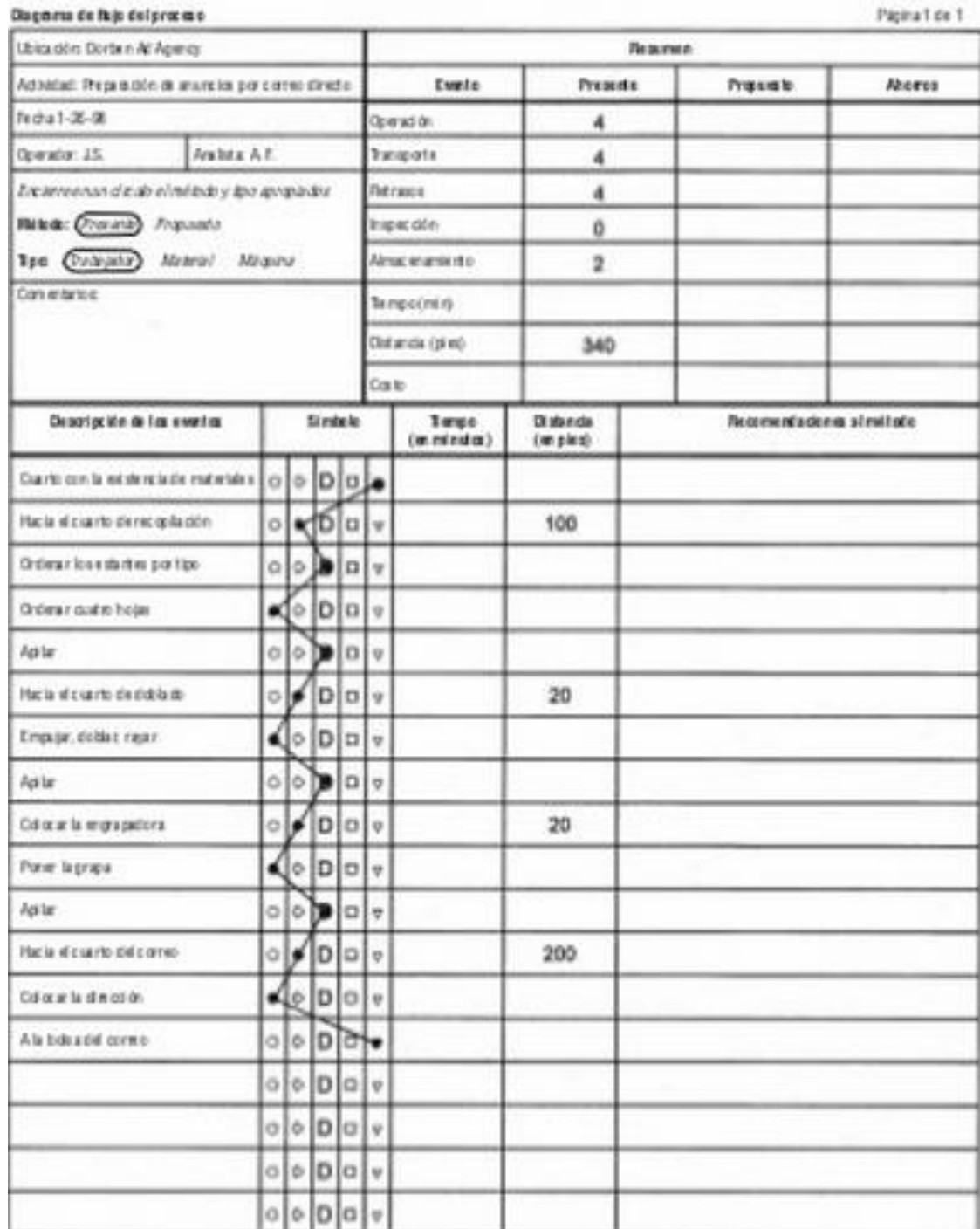
Figura 6. -Diagrama de flujo de procesos (material) para la preparación de correo. (Niebel & Freivalds, 2014) Ingeniería Industrial: Métodos Estándares y Diseños del Trabajo.
