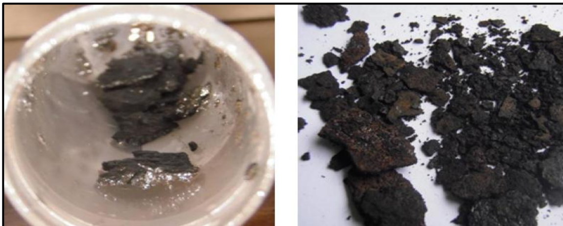
Figura 46. Productos de corrosión extraídos PK 147+749 y PK 147+749,331 (producto seco, aproximadamente 6 hs después del corte)
