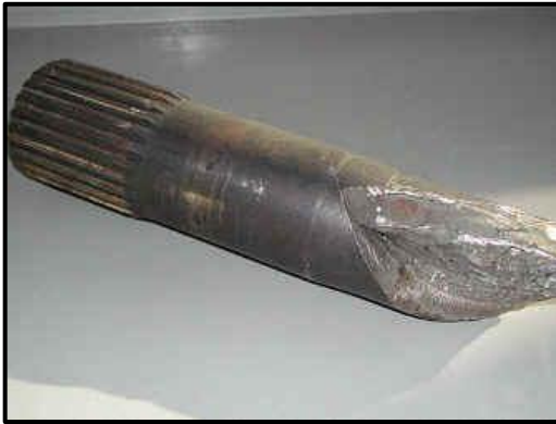
Figura 18. Corrosión por Fatiga
