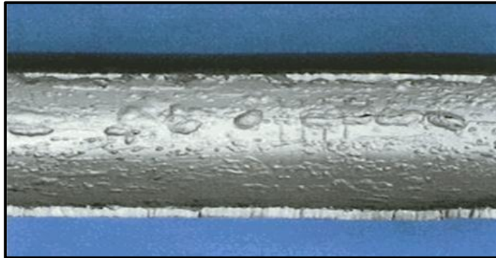
Figura 6. Corrosión por H 2 S
