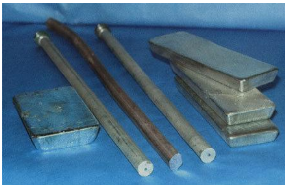
Figura 34. Diferentes formas de ánodos de sacrificio
