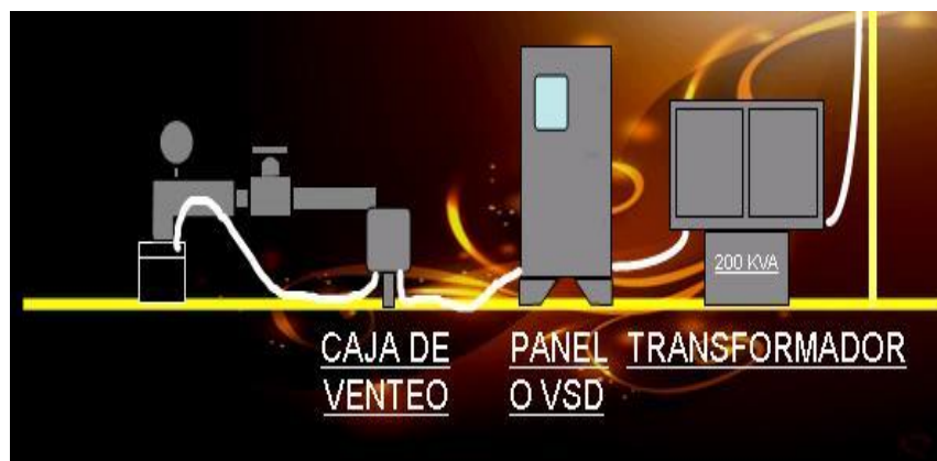
Figura 16. Vista Esquemática del Equipo de Superficie del BES.
