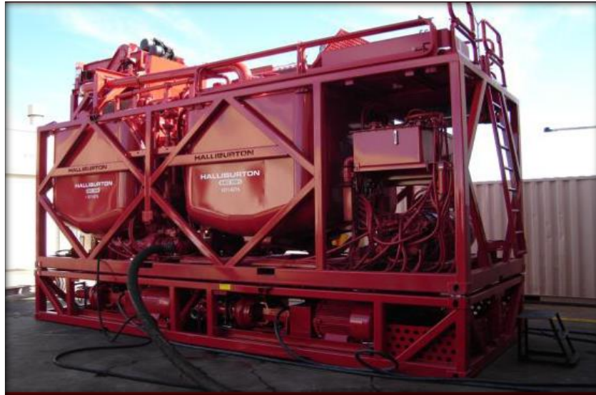
Gráfico 41. Equipo de preparación de lechada de inyección
