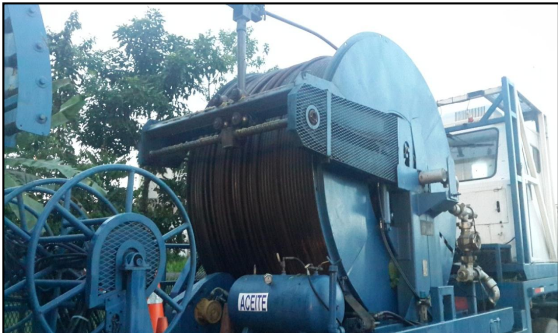
Figura 32. Carrete de almacenamiento de la tubería flexible
