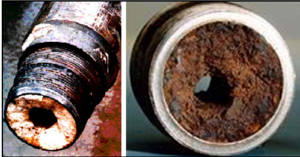
Figura 52. Tubería taponada por incrustaciones y parafina ( http://www.chemexinc.net )
