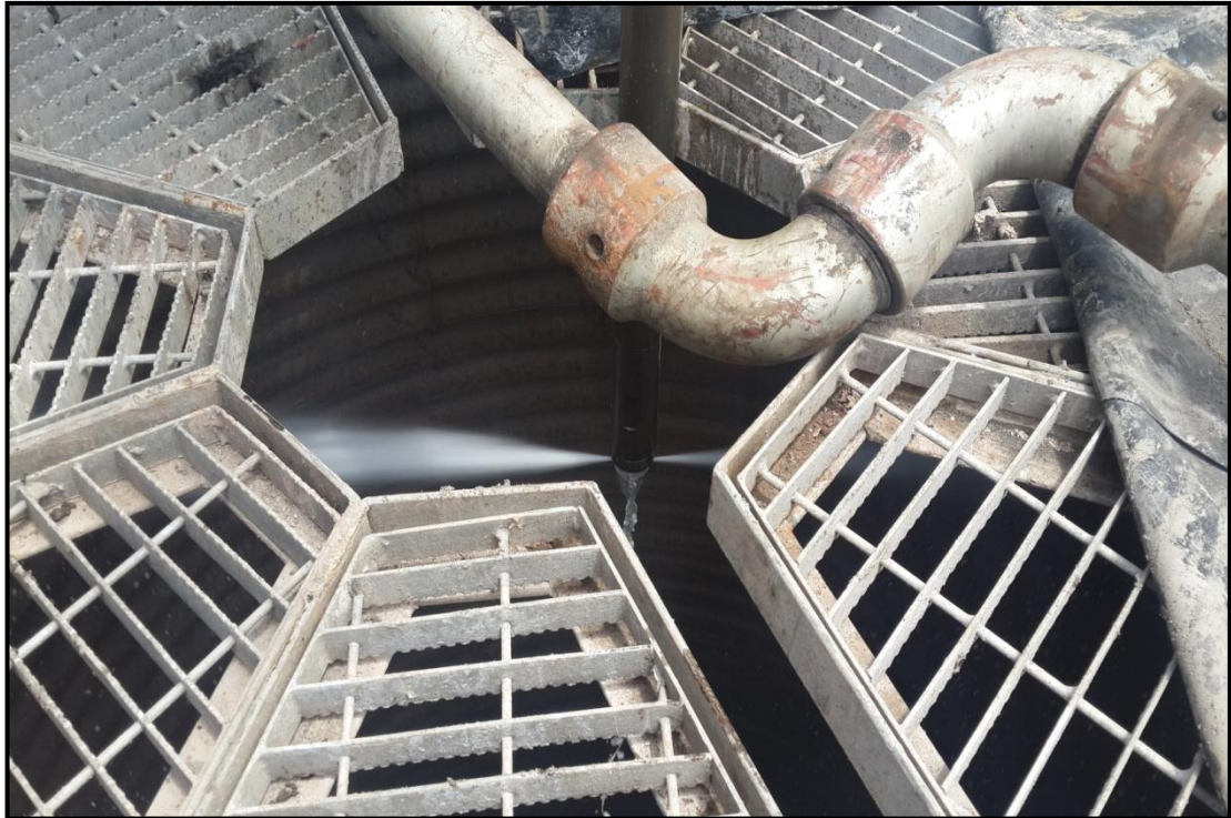
Figura 67. Prueba de Presión en la punta del Coiled Tubing
