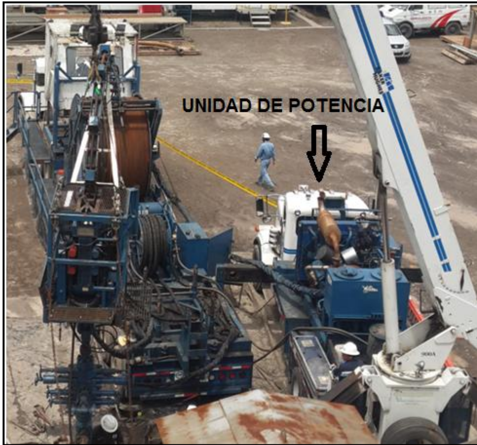
Figura 40. Camión grúa con unidad de potencia
