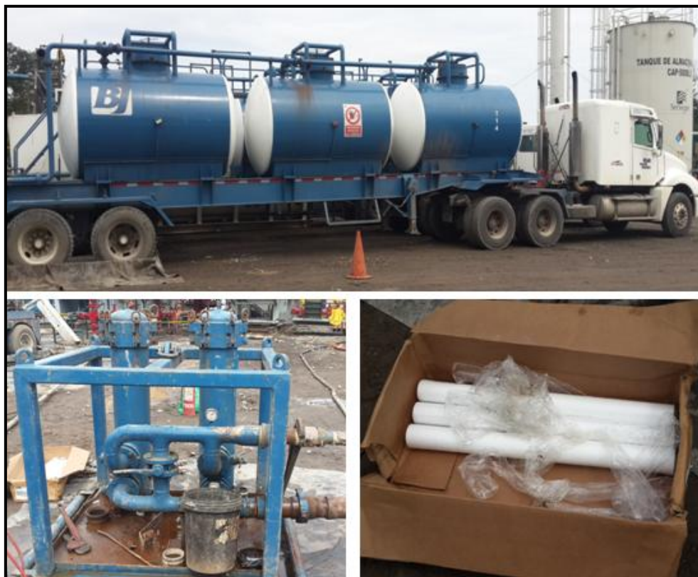
Figura 42. Camión tanque y filtros de agua
