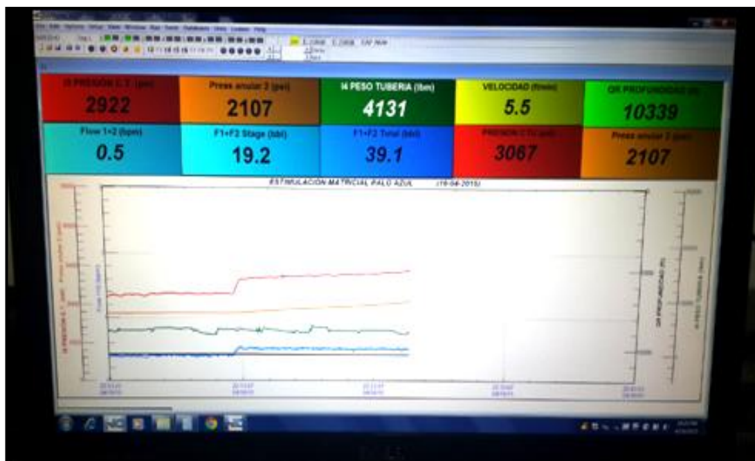
Figura 69. Monitor de control de inyección de tratamiento
