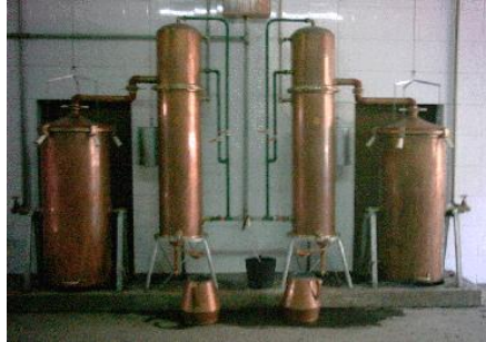
Figura 6. Destilería de aguardiente totalmente de cobre (Portugal). Ramírez de la Torre 2010.
