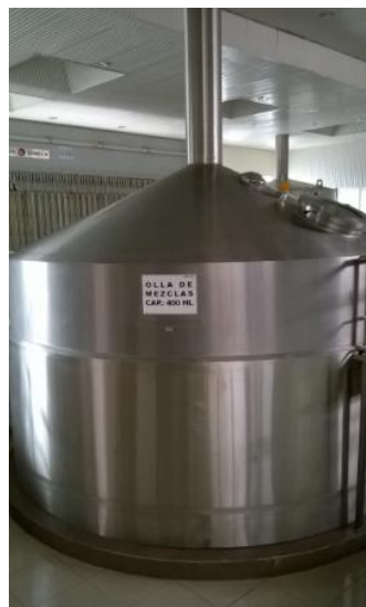
Figura 24. Olla de Mezclas de la Planta Cervecera (Cervecería Nacional, 2014)
