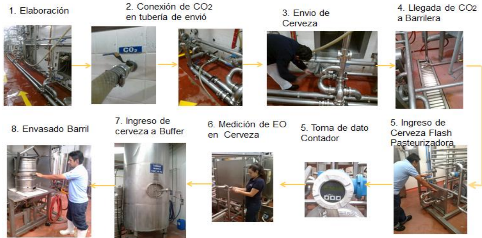
Figura 54. Diagrama POE de Empuje de Cerveza con CO 2
