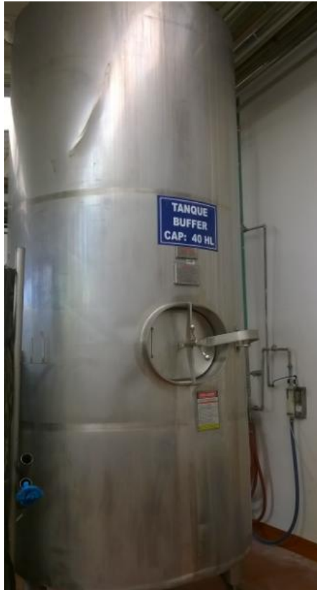
Figura 38. Tanque de Buffer para almacenamiento de Cerveza (Cervecería Nacional, 2014)
