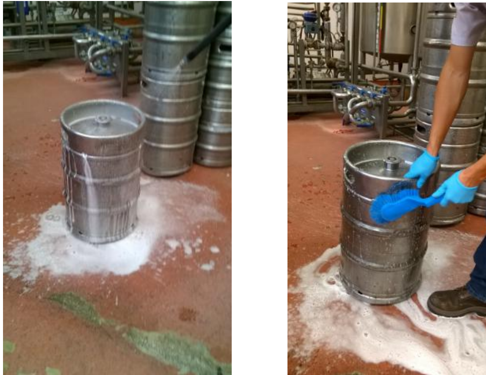
Figura 30. Lavado externo de barril de la Planta Cervecera (Cervecería Nacional, 2014)
