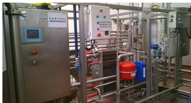
Figura 37. Control y Flash Pasteurizador (Cervecería Nacional, 2014)
