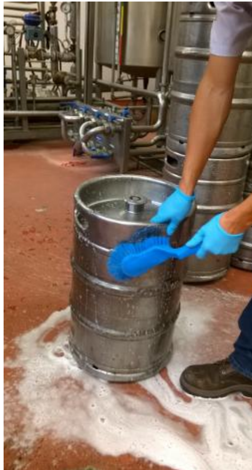
Figura 17. Fotografía de Lavado Externo del Barril (Cervecería Nacional, 2014)
