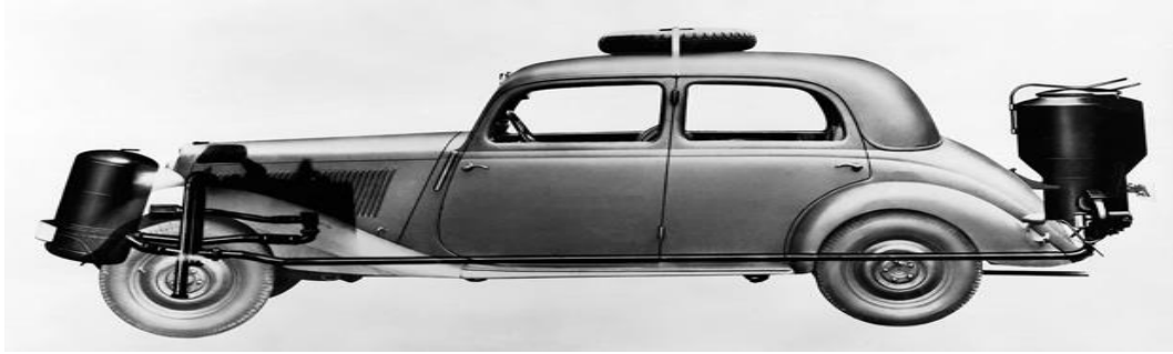
Figura 16. Automóvil funcionando con sistema de gasógeno (Low-tech Magazine,2010)
