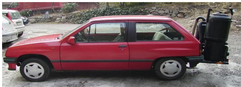
Figura 26. Auto con motor Otto y sistema de gasógeno. (Ochoa,2011)
