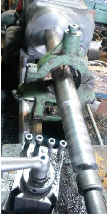
Figura 46. Desbaste del eje
