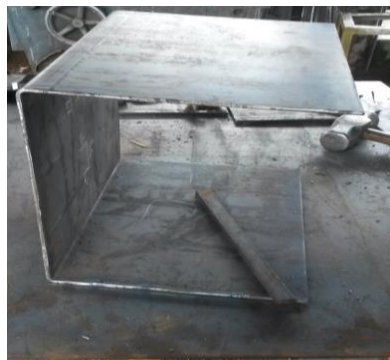
Figura 35. Tol laminado de 0.2 pulg doblado
