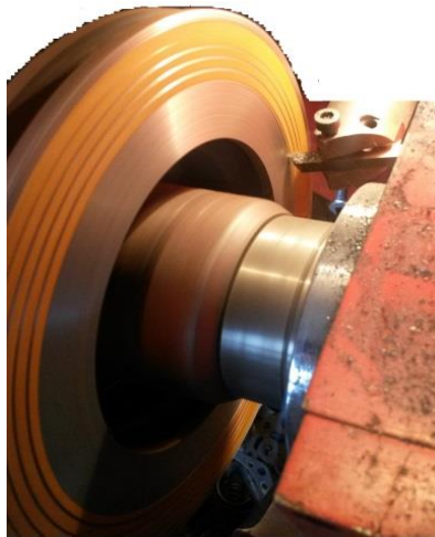
Figura 55. Rectificación de disco
