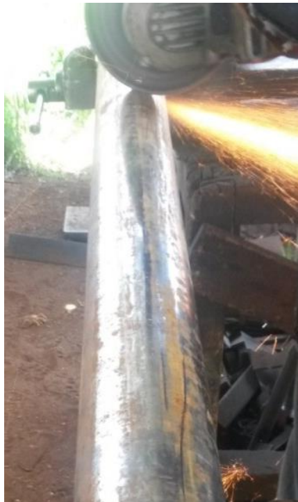
Figura 42. Corte del eje 3 ½ pulg
