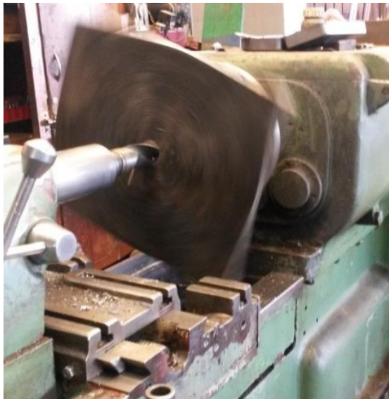
Figura 38. Trabajo en torno de la base
