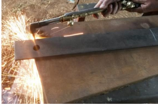
Figura 40. Corte de la plancha
