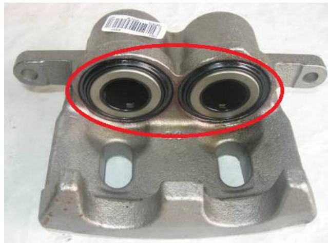
Figura 4. Cilindros de las mordazas (Muntiservicio Automotriz 3H, 2011)
