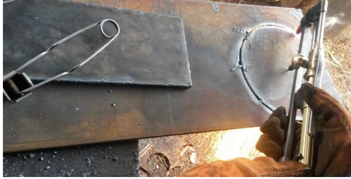
Figura 43. Fabricación de bridas
