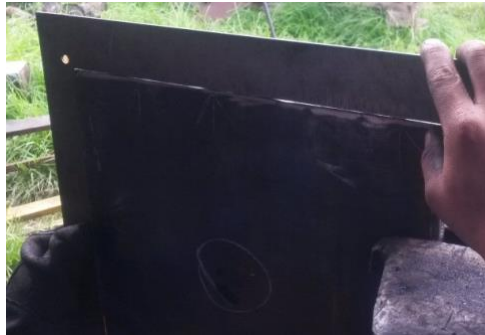
Figura 36. Medición de planitud
