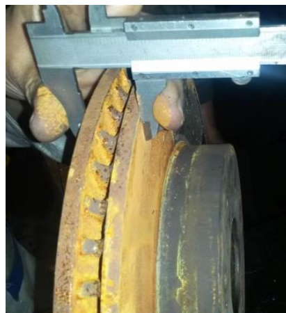
Figura 54. Medición de espesor del disco de freno
