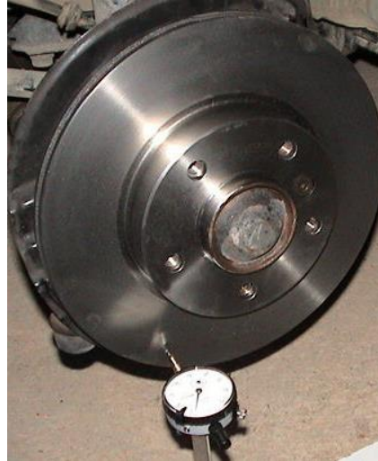
Figura 7. Medición de la ondulación del disco con un reloj comparador (Gaton, 2011)
