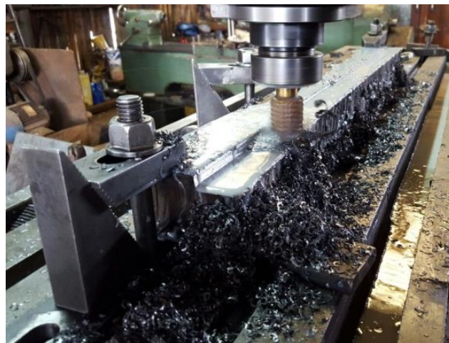
Figura 50. Rectificación de la bancada
