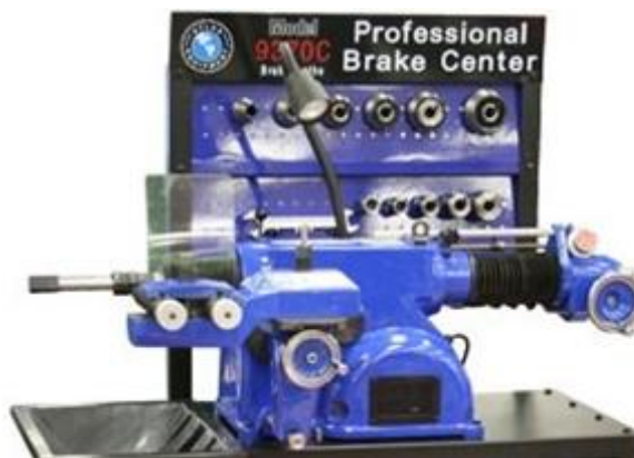
Figura 14. Rectificadora de discos (Autoequipos de Mexico, 2016)
