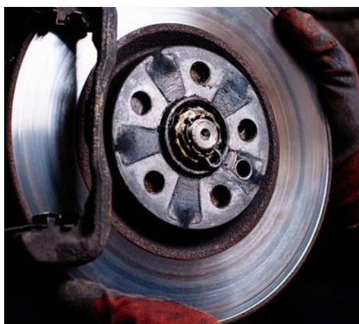
Figura 6. Disco cristalizado (AutoEspecialidades.com, 2015)
